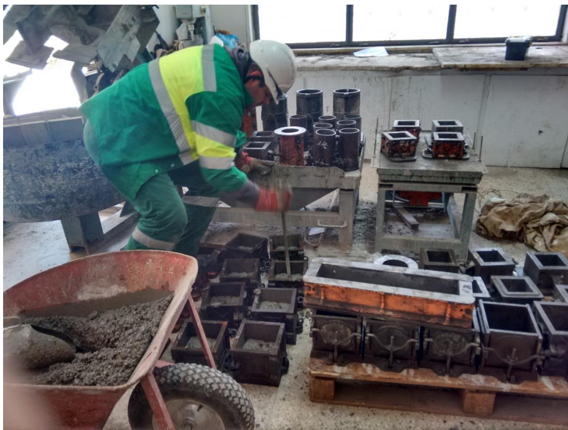
Εικόνα 2.2: Σκυροδέτηση δοκιμίων στο χώρο του εργαστηρίου ΟΣ
