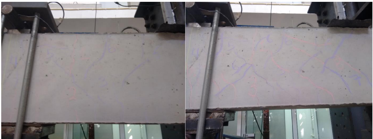
Εικόνα 3.22: Ρηγμάτωση στην μετατόπιση +\delta_y , πρώτος κύκλος (αριστερά) και -\delta_y τρίτος κύκλος (δεξιά)
