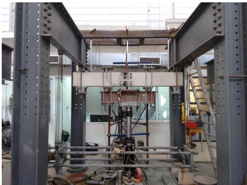
Εικόνα 3.17: Η δοκός Δ4, η πειραματική διάταξη και ο ενόργανος εξοπλισμός πριν την έναρξη του πειράματος
