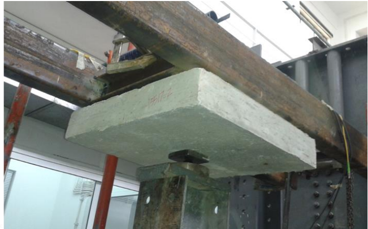
Σχήμα 2.23: Η πειραματική διάταξη των δοκιμών κάμψης εκτός επιπέδου ινοπλισμένων πλακών
