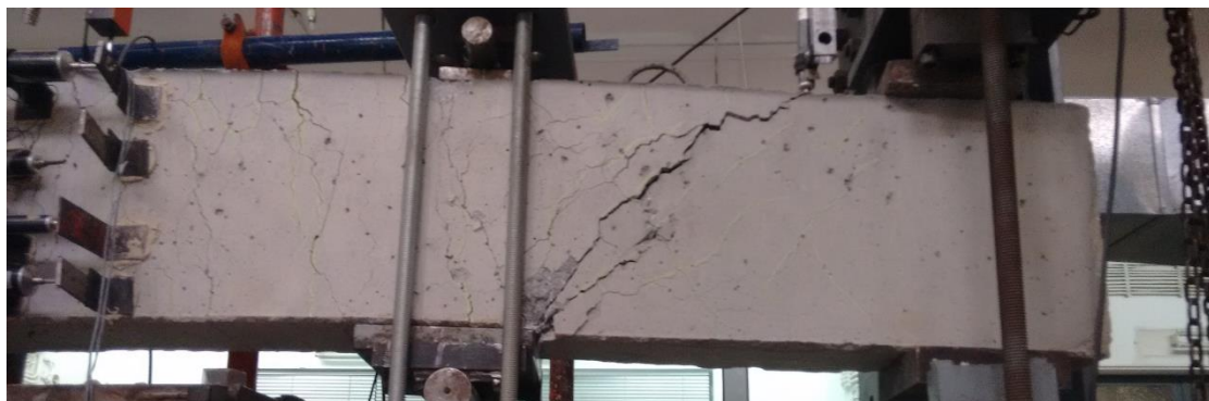
Εικόνα 3.20: Αστοχία της δοκού Δ4
