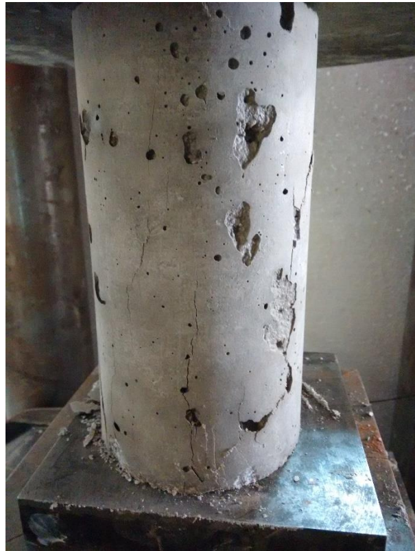
Εικόνα 2.6: Φωτογραφίες μετά την θραύση των κυλινδρικών δοκιμίων
