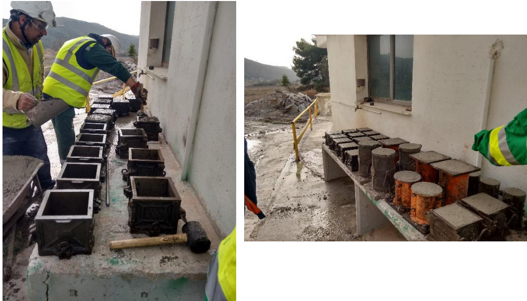
Εικόνα 2.5: Σκυροδέτηση δοκιμίων στις εγκαταστάσεις της LaFarge
