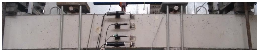
Εικόνα 3.9: Ρηγμάτωση στη μετακίνηση 2 \cdot \delta_y
