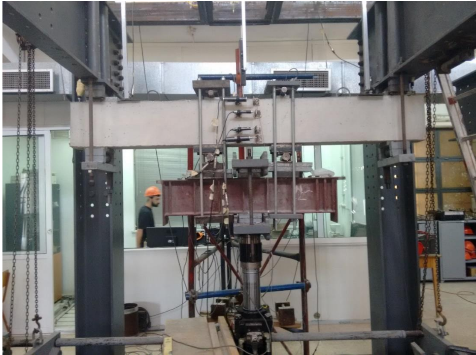
Εικόνα 3.21: Η δοκός Δ6, η πειραματική διάταξη και η ενόργανη παρακολούθηση πριν την έναρξη της δοκιμής
