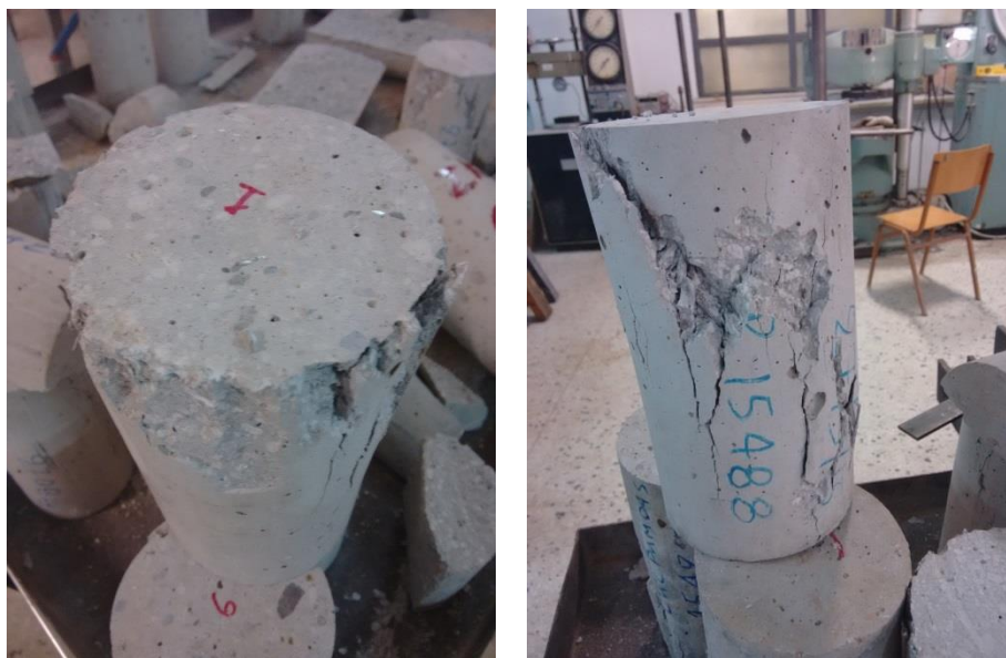
Εικόνα 2.10: Φωτογραφίες του δοκιμίου μετά τη θραύση
