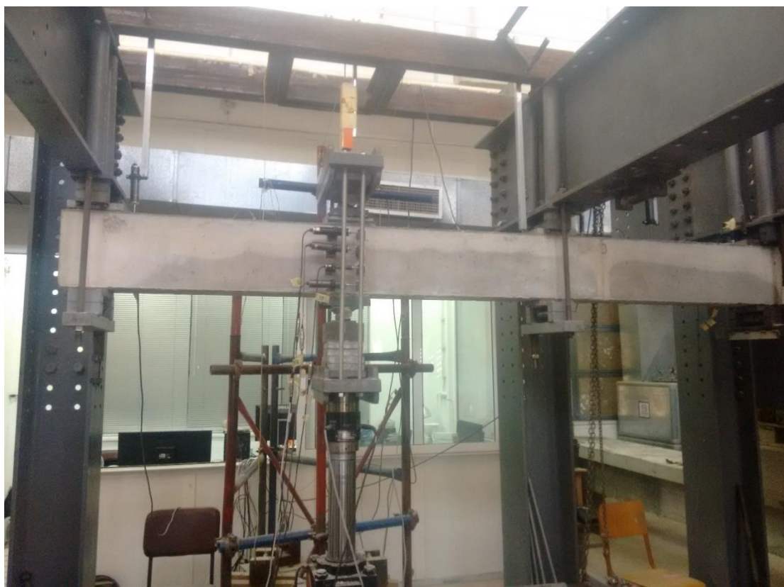
Εικόνα 3.25: Η δοκός Δ5, η πειραματική διάταξη και ο ενόργανος εξοπλισμός πριν τη δοκιμή
