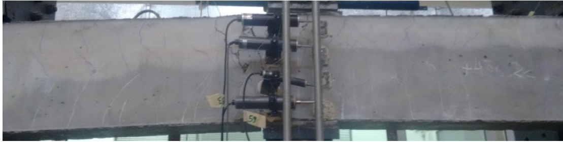
Εικόνα 3.28: Οι ρηγματώσεις στην 2 η ανακύκλιση της \delta = 4 \cdot \delta_y στο μέσο του μεγάλου ανοίγματος της Δ5
