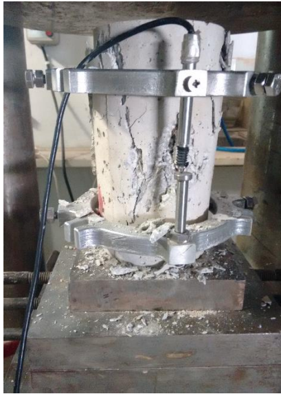
Εικόνα 2.11: Φωτογραφίες δοκιμίου μετά τη θραύση
