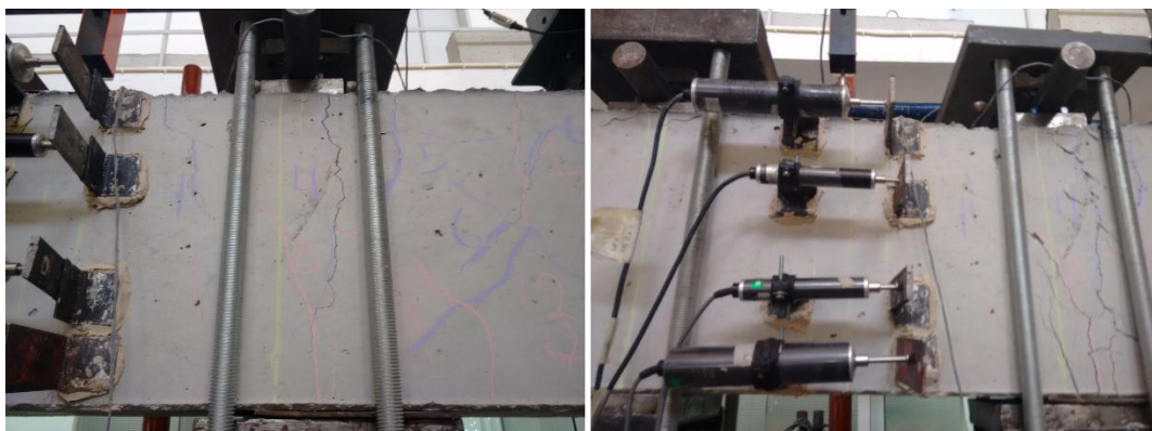
Εικόνα 3.23: Ρηγμάτωση της δοκού Δ6 στη μετακίνηση 2\delta_y - 1^{ος} κύκλος (αριστερά) και 2 \cdot \delta_y - 3^{ος} κύκλος (δεξιά)
