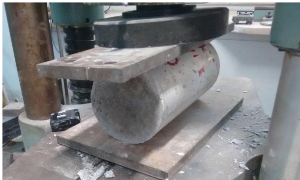
Εικόνα 2.16: Δοκιμή στη μηχανή Avery του δοκιμίου ΣΚ1_30 σε διάρρηξη
