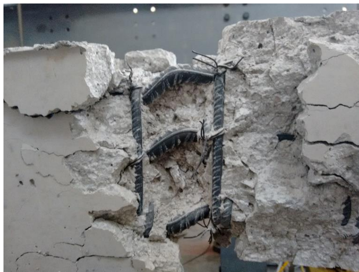
Εικόνα 3.38: Παραμόρφωση διαμήκων οπλισμών μετά την τελική αστοχία του Y2
