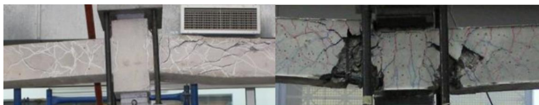
Σχήμα 3.1: Αστοχία δοκού από ΣΠΣ [NCB-S-C] (αριστερά) και από ΚΔ [LWAC-S-C1] (δεξιά) [Κωτσοβός και Μπαδογιάννης, 2013]
