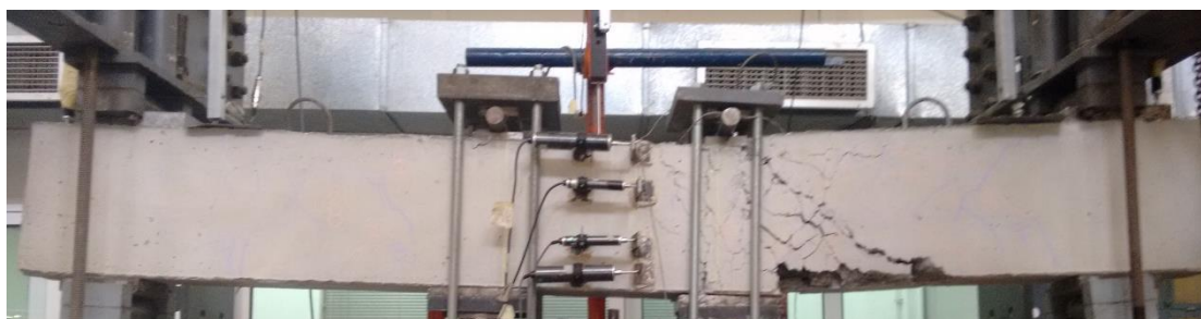
Εικόνα 3.24: Η δοκός Δ6 στην μετατόπιση -4 \cdot \delta_y , 1^{ος} κύκλος
