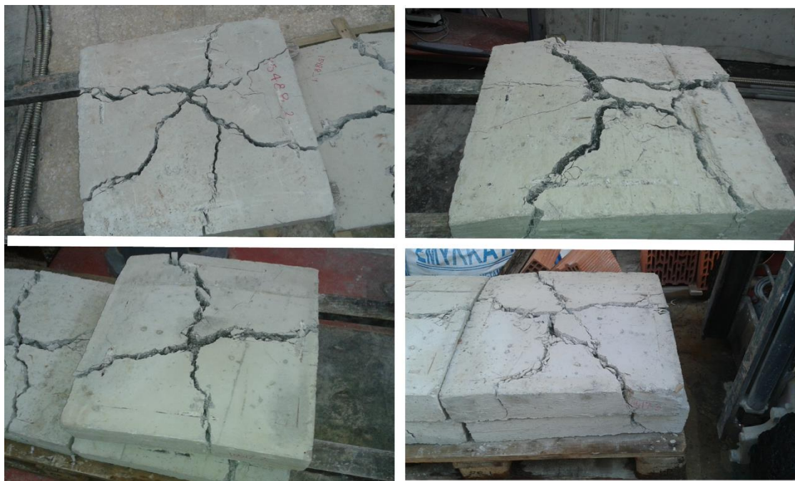
Σχήμα 2.25: Δοκίμια R15488_2, R15488_3, R15517_1 και R15517_2 μετά την αστοχία
