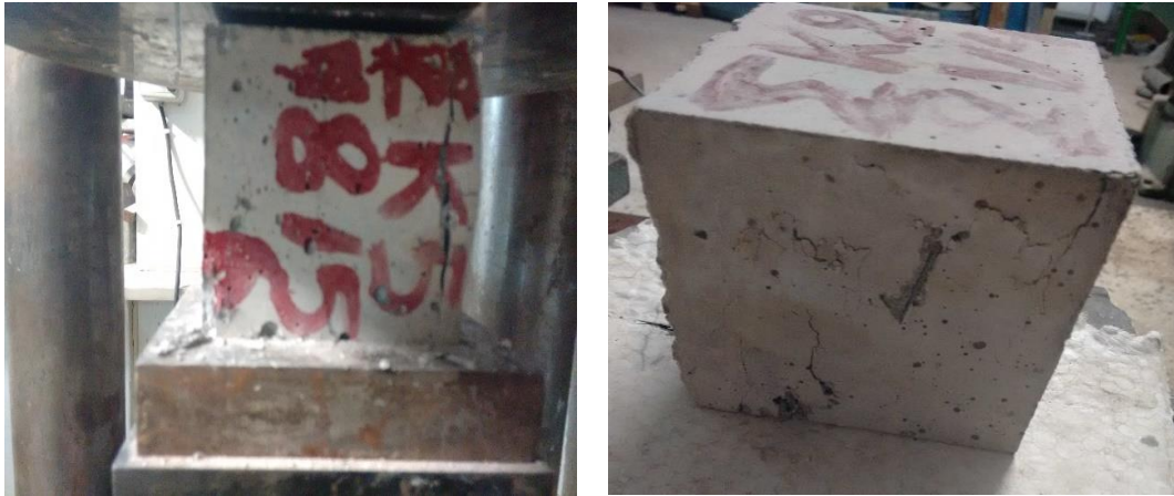
Εικόνα 2.7: Φωτογραφίες μετά την θραύση των κυβικών δοκιμίων
