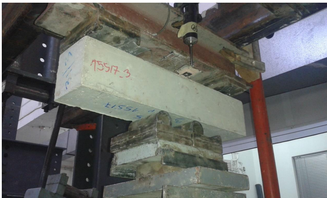
Εικόνα 2.14: Τυπική διάταξη δοκιμών εκτίμησης της καμπτικής εφελκυστικής αντοχής τεσσάρων σημείων
