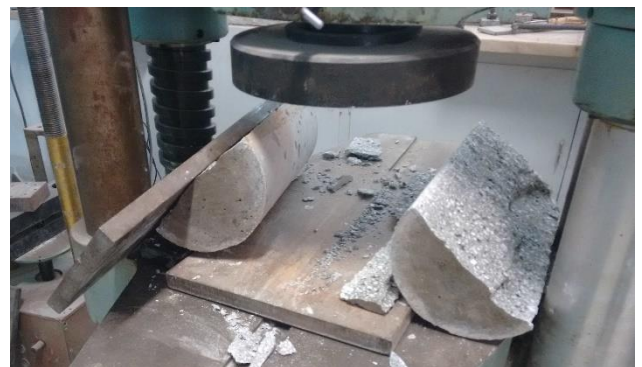
Εικόνα 2.16: Δοκιμή στη μηχανή Avery του δοκιμίου ΣΚ1_30 σε διάρρηξη
