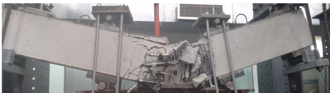
Εικόνα 3.16: Αστοχία δοκού Δ3
