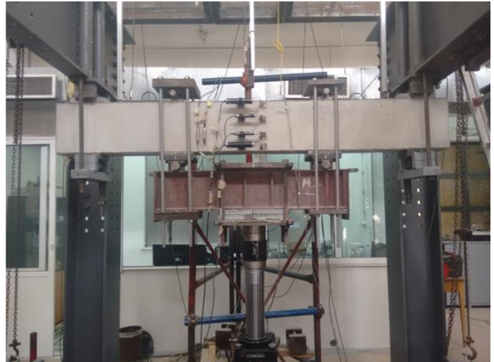
Σχήμα 3.14: Η πειραματική διάταξη της κάμψης τεσσάρων σημείων και τα μετρητικά όργανα
