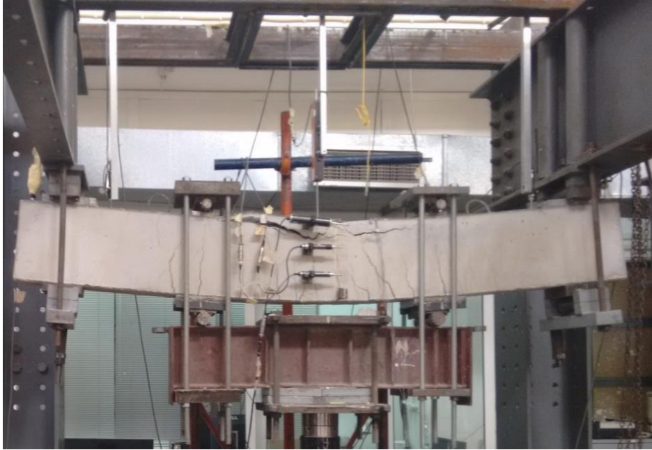
Εικόνα 3.13: Η δοκός Δ2 τη στιγμή της μέγιστης (αρνητικής) επιβαλλόμενης μετατόπισης 40 mm
