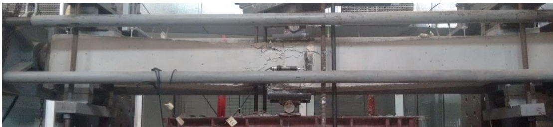
Εικόνα 3.32: Το υποστύλωμα Y1 στην αστοχία
