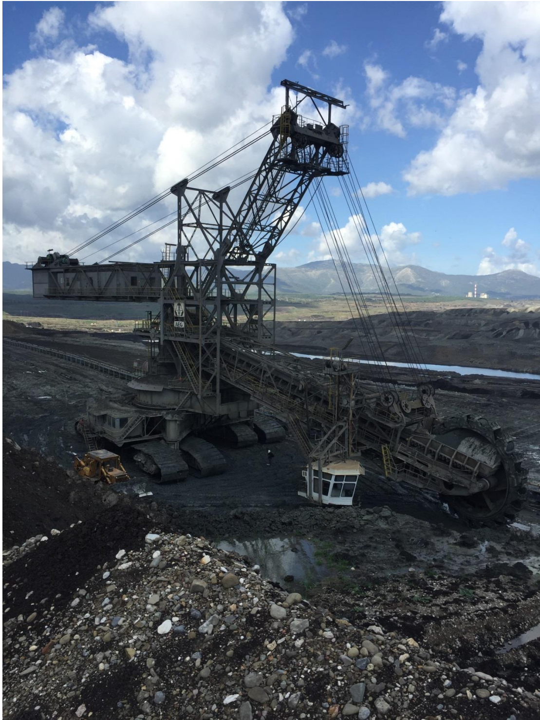
Εικόνα 3.4: Καδοφόρος εκσκαφέας σε ώρα λειτουργίας. Εκσκάπτει τμήμα ενός λιγνιτικού στρώματος στην περιοχή του νοτίου Χωρεμίου. Φαίνονται επιπλέον οι ταινιόδρομοι μεταφοράς λιγνίτη καθώς και το Νότιο μέτωπο του ορυχείου. Στο βάθος και δεξιά βρίσκεται η ατμοηλεκτρική μονάδα παραγωγής ηλεκτρικής ενέργειας της Μεγαλόπολης.
