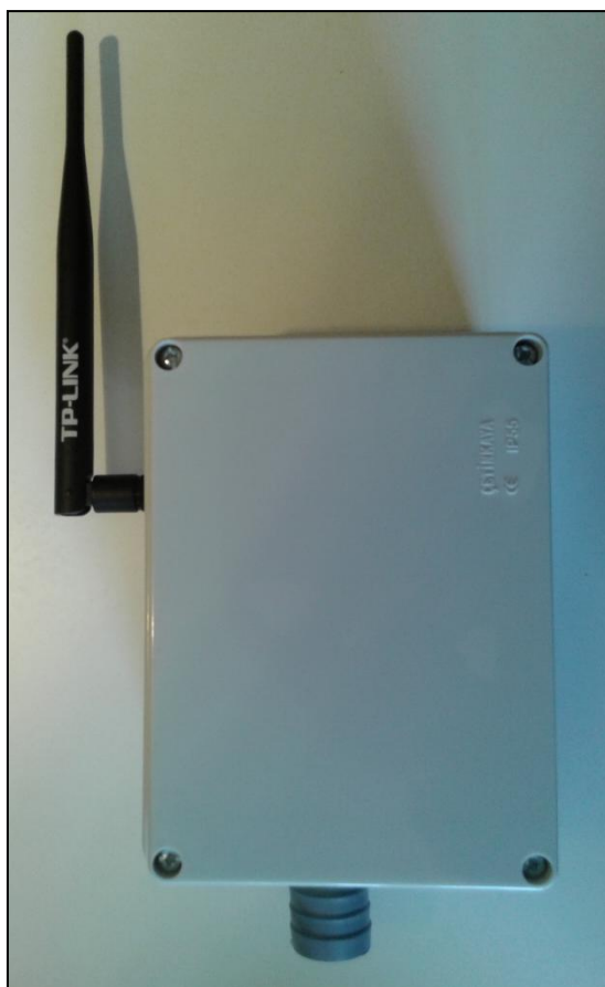
Εικόνα 5.16. Η τελική μορφή του αισθητήριου κόμβου.
