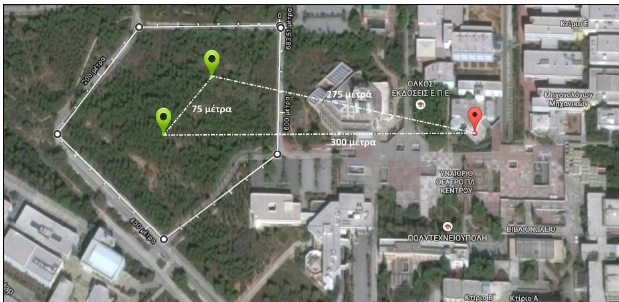
Εικόνα 4.2. Θέσεις των αισθητήριων κόμβων και του συντονιστή και οι μεταξύ τους αποστάσεις (οι κόμβοι επισημαίνονται με πράσινους δείκτες και ο συντονιστής με κόκκινο δείκτη). Ως περιοχή παρακολούθησης θεωρείται το πολύγωνο το οποίο περιέχει τους κόμβους. Οι γεωγραφικές συντεταγμένες του άνω κόμβου είναι: 37.978636, 23.780322 του κάτω κόμβου: 37.978100, 23.779893 ενώ του συντονιστή είναι: 37.978113, 23.783312.
