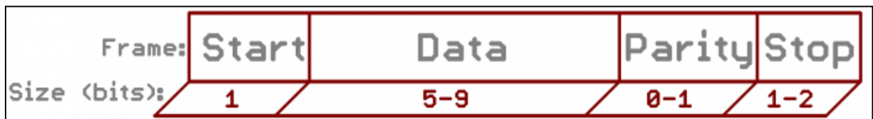
Εικόνα 3.3. Δομή ενός πακέτου δεδομένων ασύγχρονης σειριακής επικοινωνίας [14].
