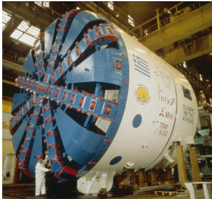
Εικόνα 1.7 Εικόνα από την Αττικό Μετρό όπου παρουσιάζεται με μπλε χρώμα η κοπτική κεφαλή του EPB που χρησιμοποιήθηκε στη διάνοιξη του μετρό της Αθήνας ( http://www.ametro.gr )
