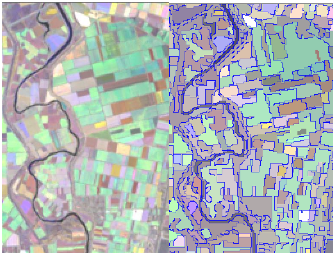
Εικόνα 18: Απεικόνιση τμήματος της περιοχής ενδιαφέροντος πριν και μετά την ολοκλήρωση της κατάτμησης με χρήση του λογισμικού eCognition.
