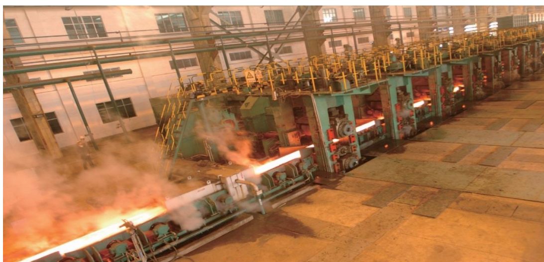
Εικόνα 12: Θερμή έλαση μπιγιέτας για παραγωγή χαλύβων.
