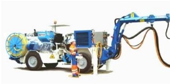
Εικόνα 8. Meycocobra για εκτόξευση ινοπλισμένου σκυροδέματος ( www.meyco.basf.com )
