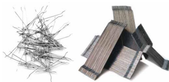
Εικόνα 11. Χαλύβδινες ίνες με γαντζωτά άκρα
