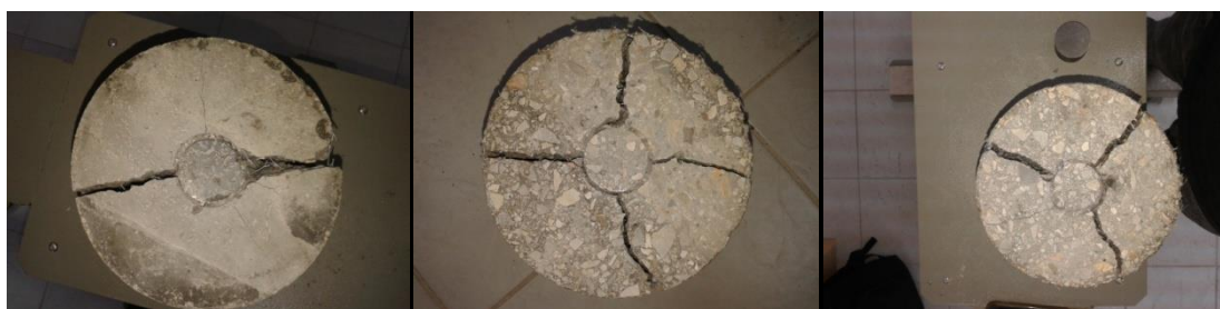
Εικόνα 45. Ρωγμές που προκαλούνται στα κυλινδρικά δοκίμια
