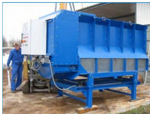
Εικόνα 4. Τροφοδότης ινών DINO 2000 (Fasertechnik, 2007)
