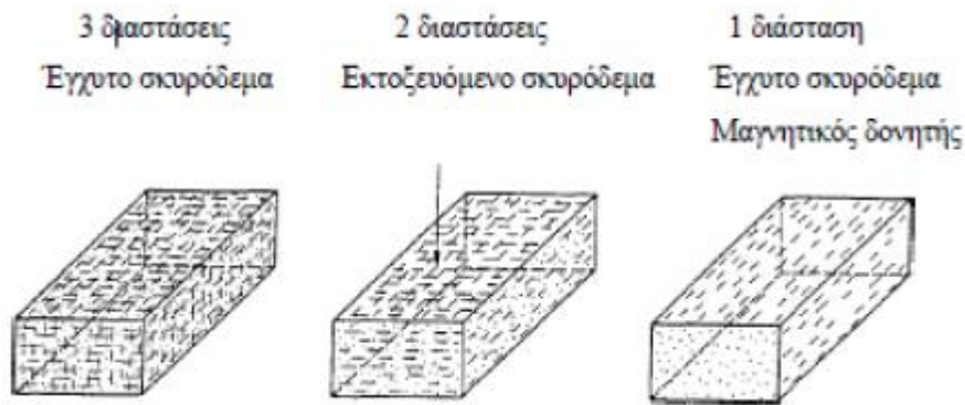
Εικόνα 13. Πιθανοί προσανατολισμοί των ινών στο σκυρόδεμα (Maidl, 1995)
