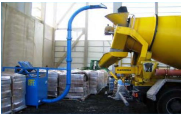
Εικόνα 6. Τροφοδότης ινών DINO 60 (Fasertechnik,2007)
