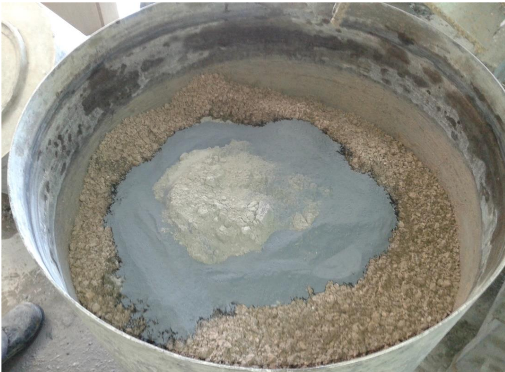
Εικόνα 26. Προσθήκη τσιμέντου και πυριτικής παιπάλης μετά από μερική ανάδευση των αδρανών με νερό
