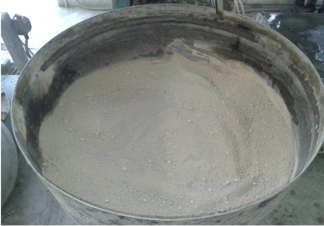
Εικόνα 25. Προσθήκη αδρανων υλικών για ανάδευση
