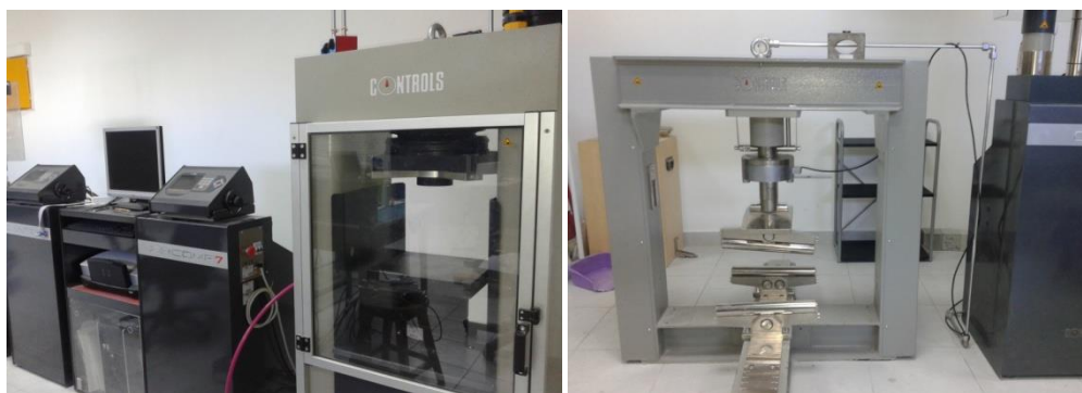
Εικόνα 34.Πλαίσιο κάμψης δυναμικότητας φόρτισης 150kN και δοκιμών θλίψης δυναμικότητας 5000 kN και μονάδα ελέγχου τριαξονικών δοκιμών Sercomp 7
