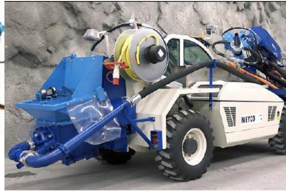
Εικόνα 9. Meycoroca για εκτόξευση ινοπλισμένου σκυροδέματος ( www.meyco.basf.com )
