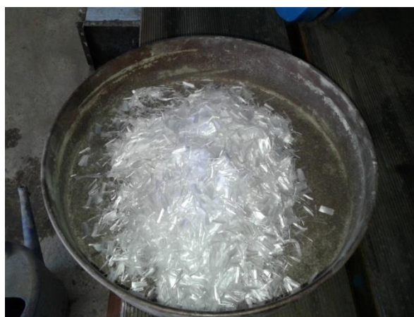
Εικόνα 16.Συνθετικές ίνες πολυπροπυλενίου PPF2
