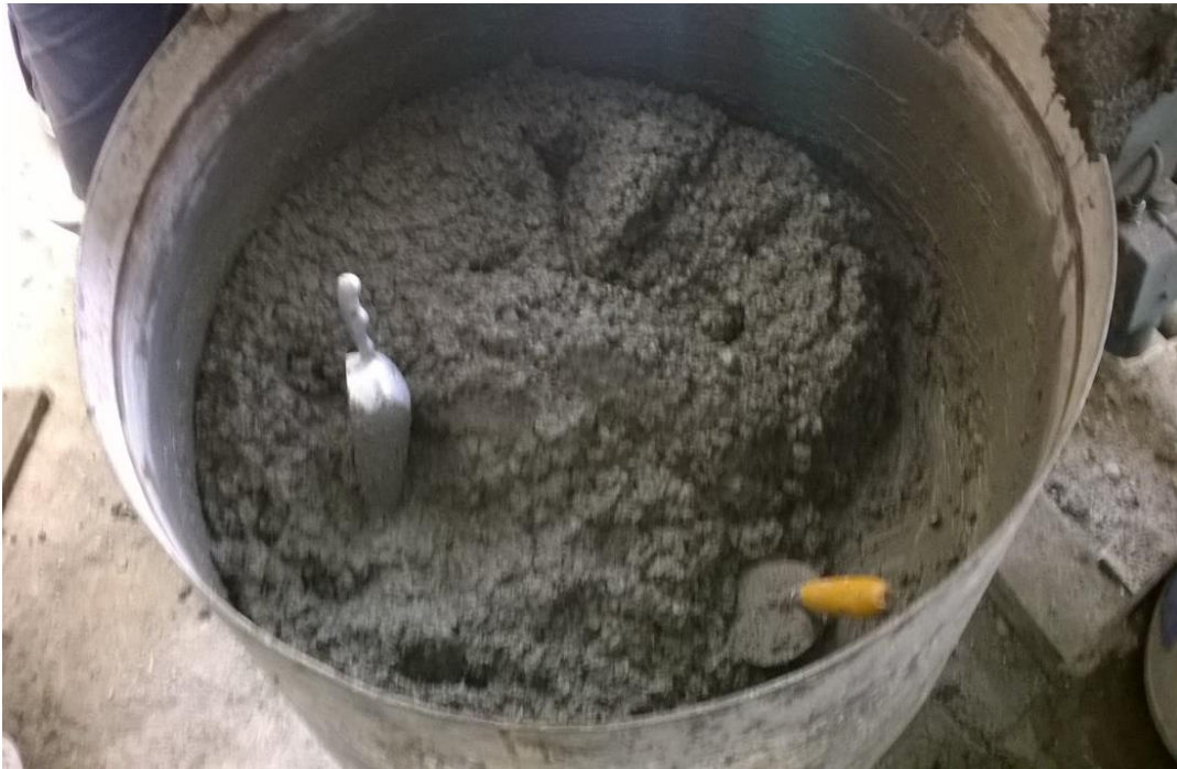
Εικόνα 27. Τέλειο μίγμα μετά την προσθήκη ινών και του ρευστοποιητή
