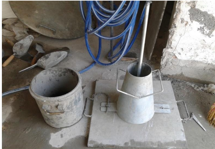
Εικόνα 28. Κώνος κάθισης και ράβδος συμπτκνώσεως
