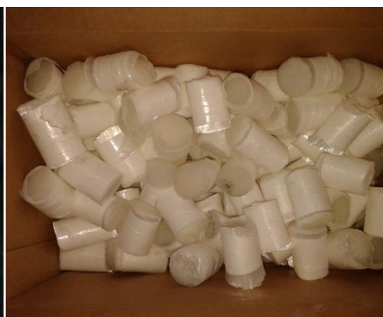
Εικόνα 17.Συνθετικές ίνες πολυπροπυλενίου PPF1
