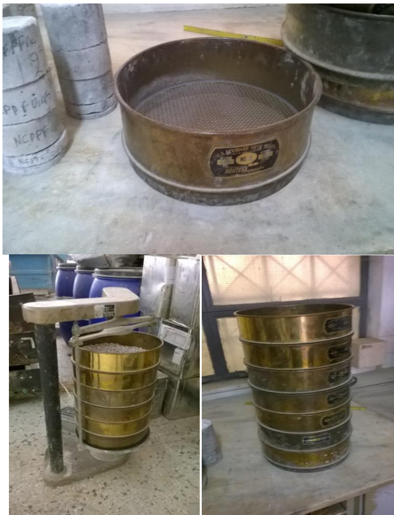
Εικόνα 21. Κόσκινο, σειρά κοσκίνων και συσκευή κοσκινίσματος
