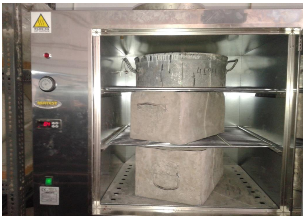
Εικόνα 19. Φούρνος ξήρανσης αδρανών
