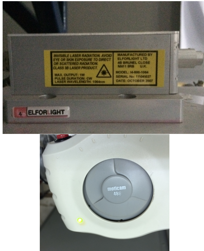
Σχήμα 6.1: Laser Nd:YAG, με μήκος κύματος 1064nm, και η CCD κάμερα, που χρησιμοποιήθηκαν στην οπτική παγίδευση
