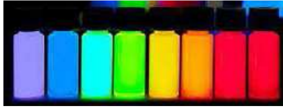
Σχήμα 3.6: Κατά την ακτινοβόληση διαλύματος μεταλλικών νανοσφαιριδίων, αυτά δίνουν διαφορετικό χρώμα ανάλογα με το μέγεθος και το υλικό τους [31]
