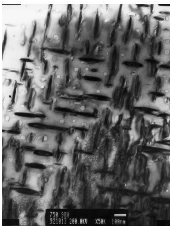
Εικόνα 9 - Δισκοειδής φάση \gamma'' και σφαιρική \gamma' σε Inconel 718 μετά από παραμονή στους 750°C για 100h
