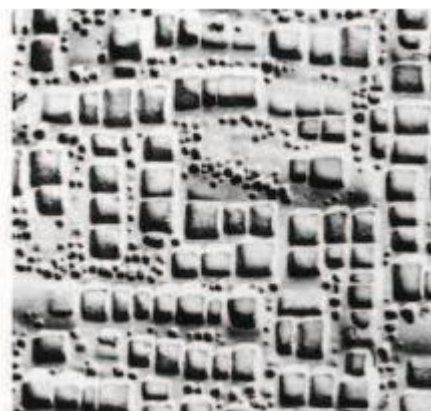
Εικόνα 4 - Φάση γ' κυβικής μορφολογίας
