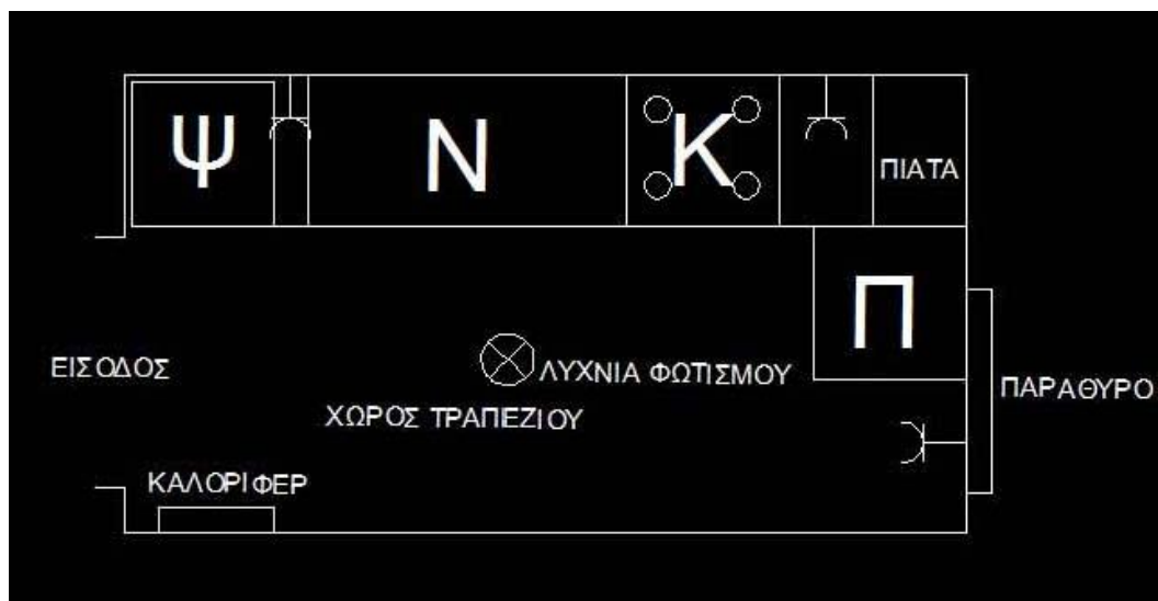
Σχήμα 4.9. Κάτοψη κουζίνας διαμερίσματος Βύρωνα.
