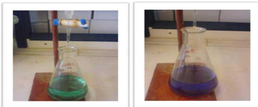
Εικόνα 27: Πριν και μετά την τιτλοδότηση κατά τη μέθοδο προσδιορισμού του αζώτου των δειγμάτων
