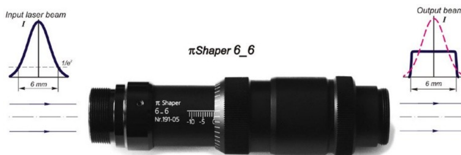
Σχήμα 163: Αρχή λειτουργίας διαμορφωτή δέσμης
