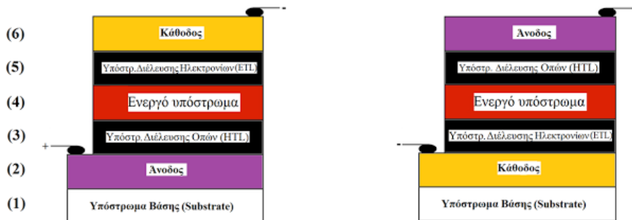
Σχήμα 43: Κανονική και ανεστραμμένη διάταξη οργανικής φωτοβολταϊκής κυψελίδας
