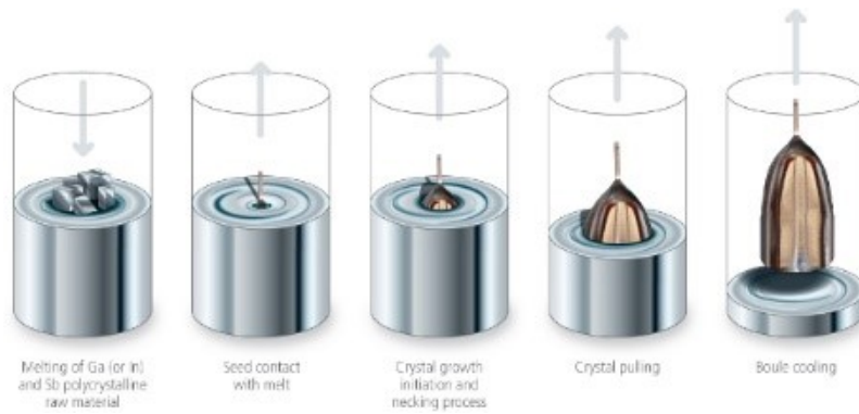
Σχήμα 29: Διαδικασία παραγωγής της μεθόδου Czochralski
