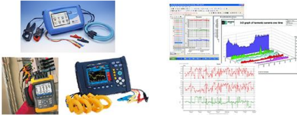
Εικόνα 2.2: Φορητοί αναλυτές ποιότητα ισχύος Εικόνα από διαφάνειες μεταπτυχιακού μαθήματος «Ποιότητα ισχύος» ΕΜΠ
