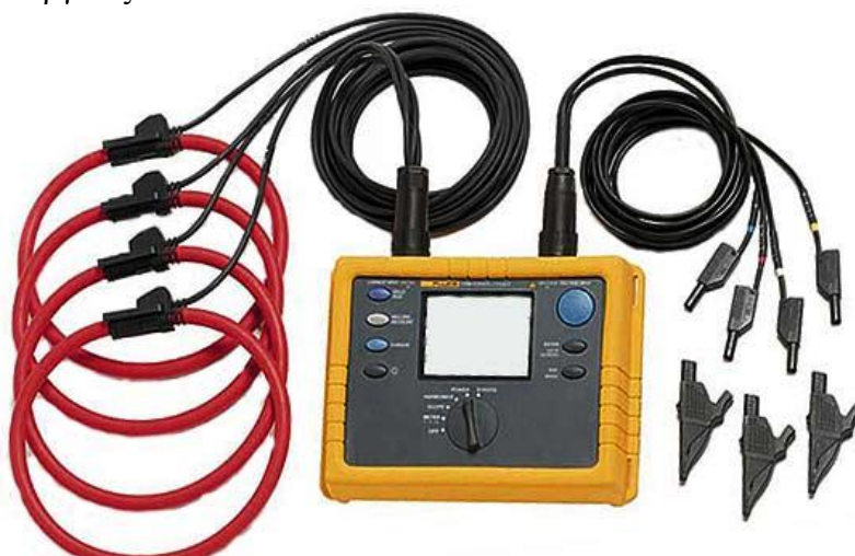
Εικόνα 3.2: Αναλυτής Ηλεκτρικής Ενέργειας Fluke 1735
