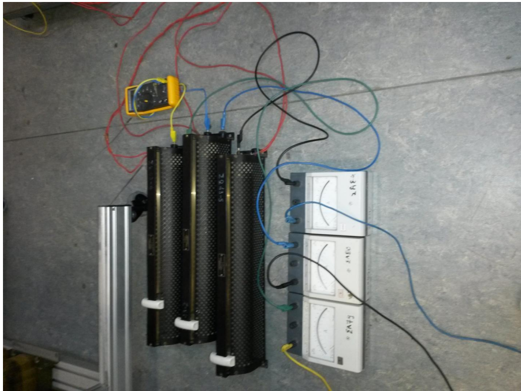
Σχήμα 5.2 : Αντιστάσεις για επιθυμητό ρεύμα γραμμής
