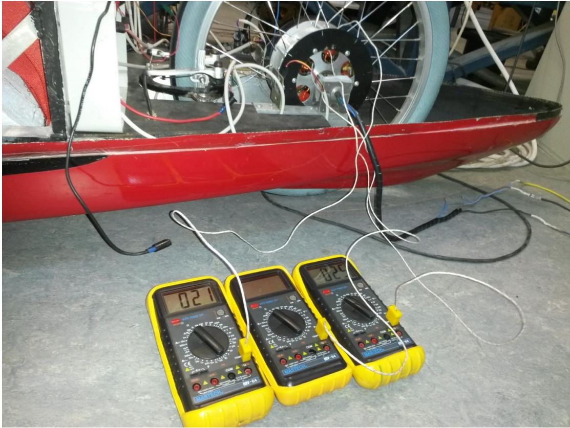
Σχήμα 5.4 : Καταγραφή θερμοκρασιών μέσω ψηφιακών πολυμέτρων
