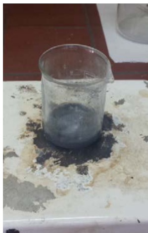
Σχήμα 2.12 Πρόοδος σύνθεσης αιωρήματος PDMS-AgNO 3 powder.
