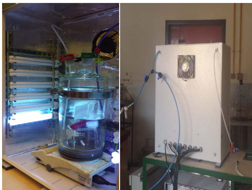
Σχήμα 2.1 Αριστερά : Αντιδραστήρας φωτοκατάλυσης, Δεξιά: Φωτοκαταλυτική διάταξη.
