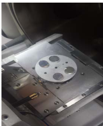
Εικόνα 3.1 Επιχρυσωμένα δείγματα μέσα στο θάλαμο του SEM.
