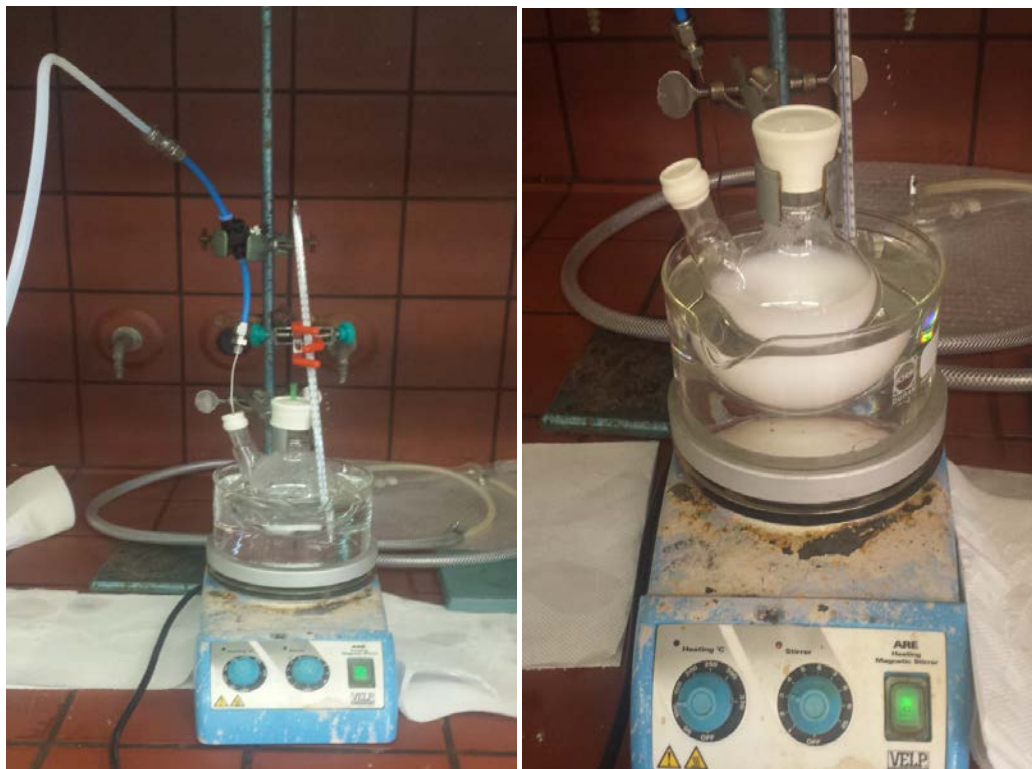
Σχήμα2.25 Πρόοδος πολυμερισμού: Αριστερά πριν την ένεση εκκινητή. Δεξιά μετά την ένεση εκκινητή, παρατηρείται αλλαγή στο χρώμα.
