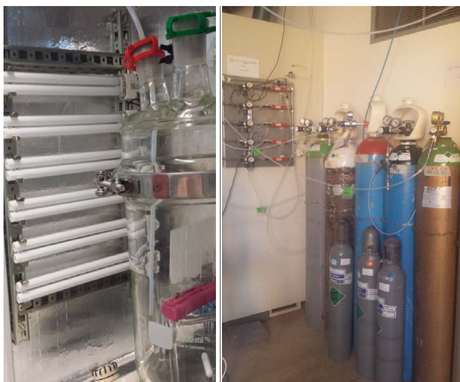
Σχήμα 2.2 Λάμπες PHILIPS P-LS 11W UVA -Φιάλες αερίων και Mass Flow Controllers.
