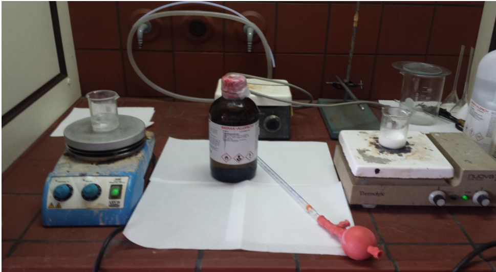
Σχήμα 2.6 Πειραματική διάταξη παρασκευής συνθέτων δειγμάτων 1.
