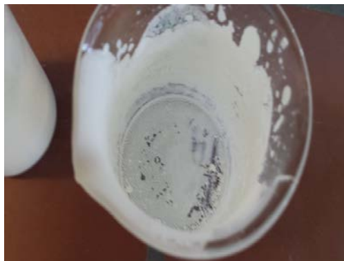
Σχήμα 2.10 Ξήρανση του αιωρήματος στον αέρα προς συλλογή σκόνης δείγματος.
