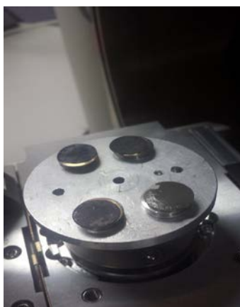
Σχήμα 2.37 Επιχρυσωμένα δείγματα και τοποθετημένα στο θάλαμο του ηλεκτρονικού μικροσκοπίου.
