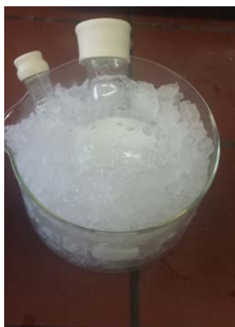
Σχήμα 2.26 Τερματισμός πολυμερισμού σε λουτρό πάγου.
