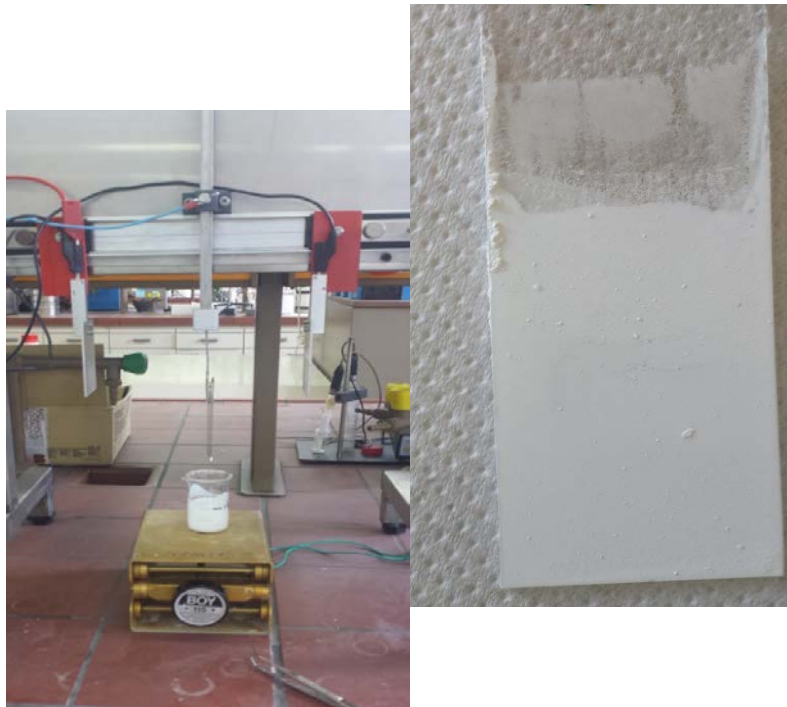
Σχήμα 2.9 Αριστερά: Διαδικασία επίστρωσης με deep coating. Δεξιά: Τελική μορφή επικαλυμμένου γυάλινου επιστρώματος με αιώρημα με τη διαδικασία deep coating.
