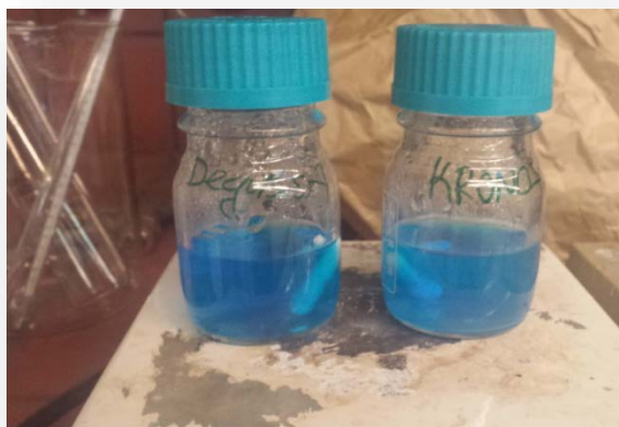
Σχήμα 3.17 Δείγματα αιωρημάτων MB\ 2 \times 10^{-5}\ M –Degussa και MB\ 2 \times 10^{-5}\ M –Kronos 1077 μετά από 20 ώρες χωρίς φωτοβόληση.
