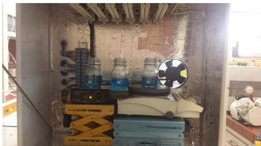
Σχήμα 2.4 Εσωτερικό διάταξης φωτοκατάλυσης υδάτινων ρύπων.
