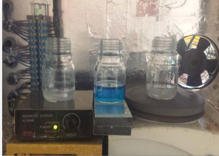
Σχήμα 3.21 Πλήρως αποδομημένα δείγματα μετά από 20 ώρες φωτοβόλησης UV, στη μέση το αναλλοίωτο MB χωρίς προσθήκη καταλύτη.
