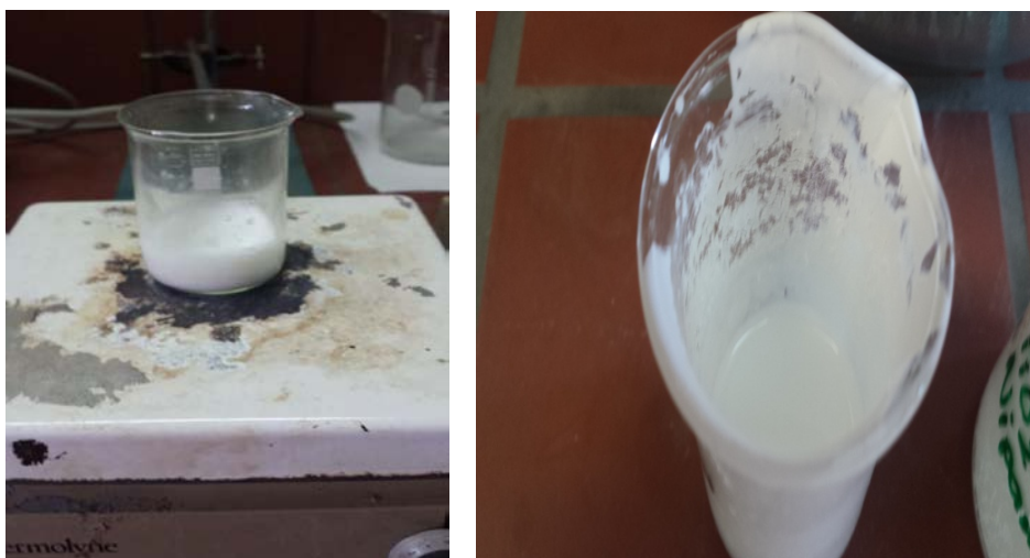
Σχήμα 2.8 Αριστερά: υφή και όψη αιώρηματος λίγο πριν την τελική μορφή του, Δεξιά: Τελική μορφή αιώρηματος έτοιμο προς επίστρωση στα υποστρώματα.
