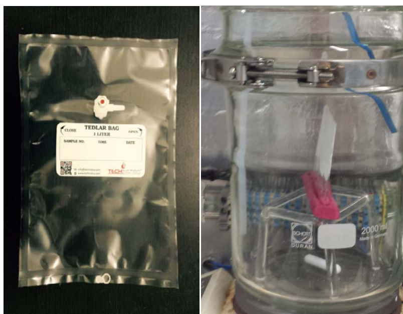
Σχήμα 3.5 Αριστερά: TEDLAR BAG για συλλογή αερίου. Δεξιά: Στήριγμα δοκιμίων εντός του αντιδραστήρα.
