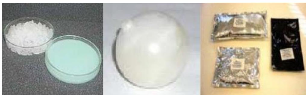
Σχήμα 2.12 Ανόργανα υλικά αλλαγής φάσης. Ένυδρα άλατα μη συσκευασμένα, ένυδρα άλατα σε κάψουλες, ένυδρα άλατα σε σακούλες. [16]
