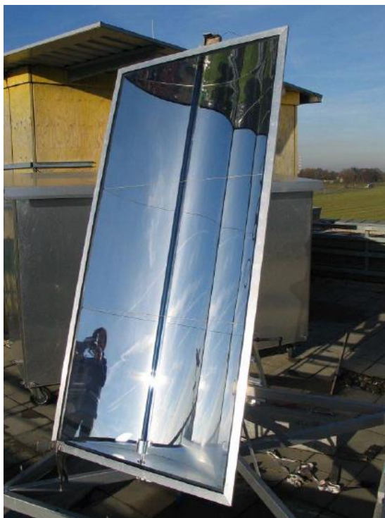
Σχήμα 2.6 Ηλιακός παραβολικός συλλέκτης PTC-1000 [42]
