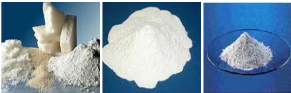
Σχήμα 2.11 Οργανικά υλικά αλλαγής φάσης. Παραφίνες μη συσκευασμένες, παραφίνες σε μικροκάψουλες, παραφίνες σε κάψουλες [16]
