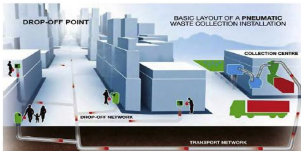
Εικόνα 12 Λειτουργία συστήματος stationary pipe
