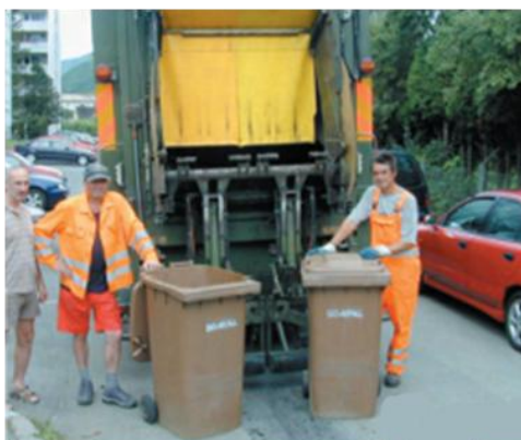
Εικόνα 21 Συλλογή βιοαποβλήτων με απορριματοφόρο ταυτόχρονης ανύψωσης δύο κάδων
