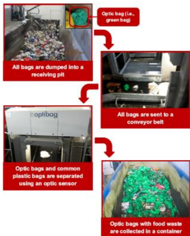
Εικόνα 15 Οπτικός διαχωρισμός σε σύστημα ENVAC στην Σουηδία
