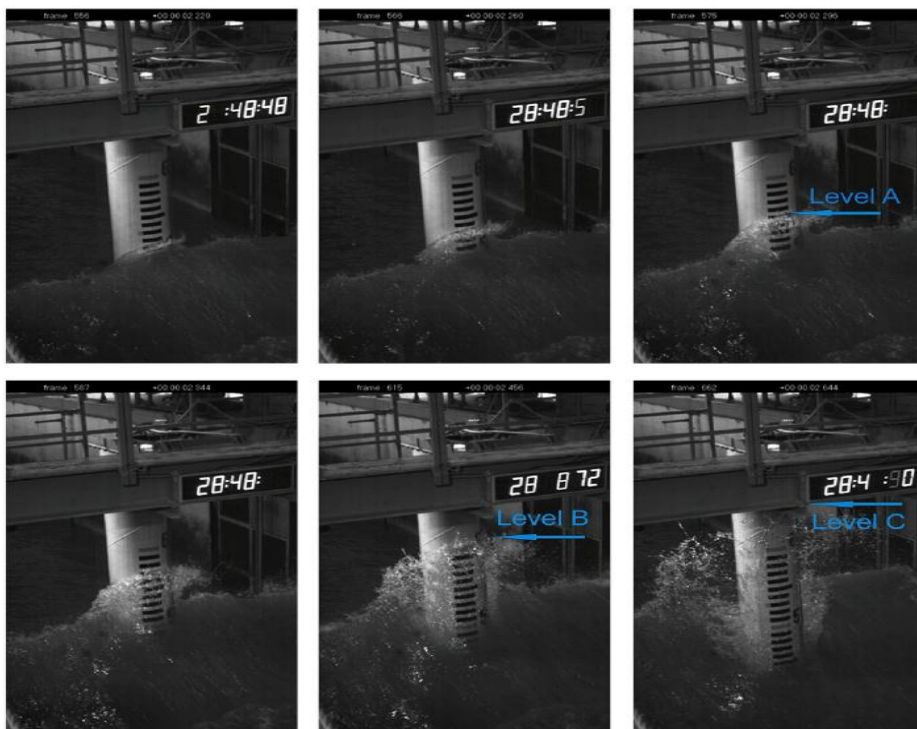
Εικόνα 1.4: Μπροστινή απεικόνιση αναρρίχησης κυματισμού που συναντά κύλινδρο κατά την διάδοσή του, κατά την εκτέλεση πειράματος [3].
