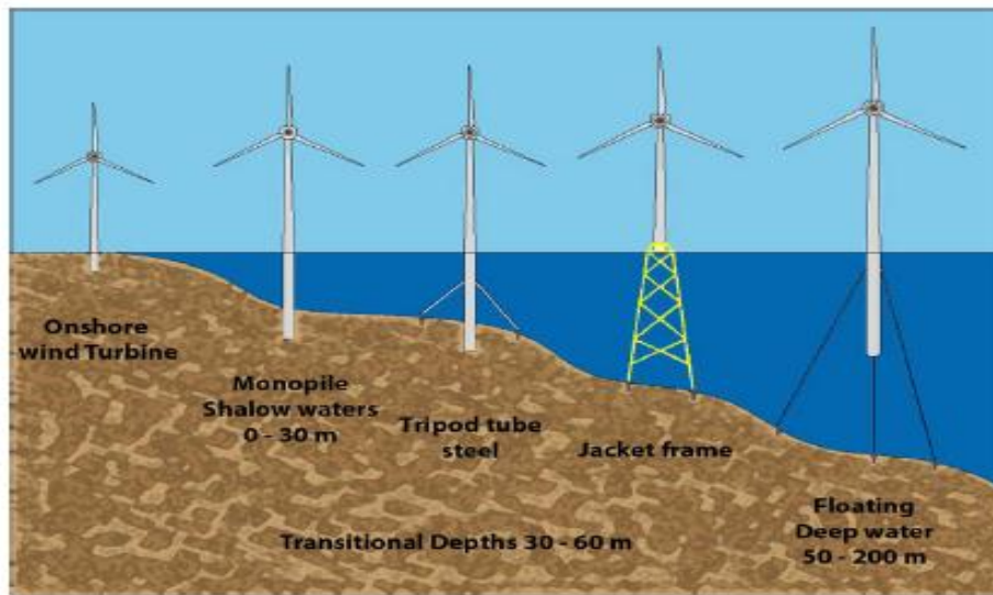
Εικόνα 2.4: Σχηματική περιγραφή των σύγχρονων κατηγοριών ανεμογεννητριών. [5]
