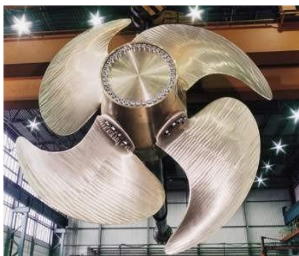
Σχήμα 3.6: Σύγχρονη τετράπτερη έλικα με μεγάλη πλευρική απόκλιση (highly skewed) ρυθμιζόμενου βήματος (controllable pitch)
