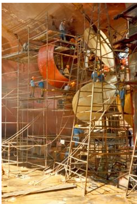
Σχήμα 8.3: Τοποθέτηση δακτυλίου εξισορρόπησης ροής σε ναυπηγείο
