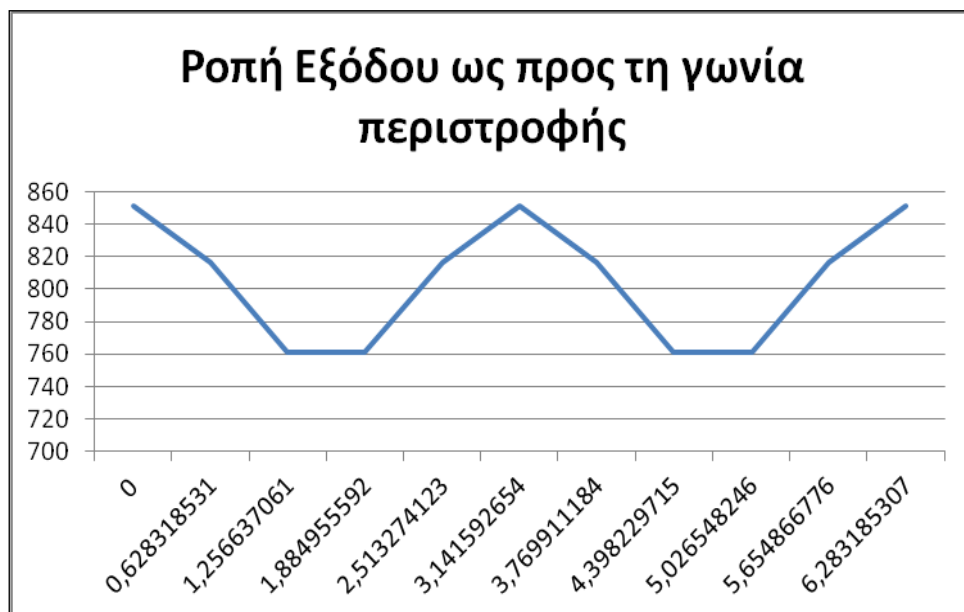
Σχήμα 2.7 Ροπή εξόδου ως προς τη γωνία περιστροφής για ταχύτητα εισόδου \Omega_{in} = 2000 rpm
