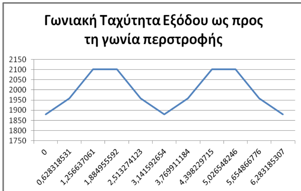
Σχήμα 2.6 Γωνιακή ταχύτητα εξόδου ως προς τη γωνία περιστροφής για ταχύτητα εισόδου \Omega_{in} = 2000 rpm
