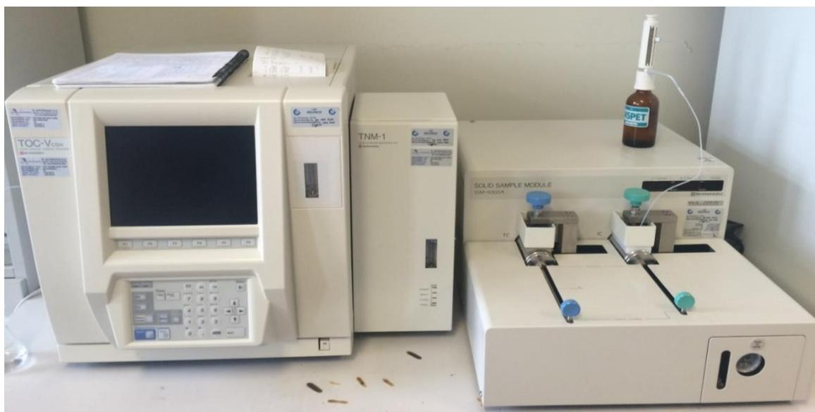
Εικόνα 23: Συσκευή προσδιορισμού οργανικού άνθρακα σε στερεά και υγρά δείγματα (TOC-V) Shimadzu
