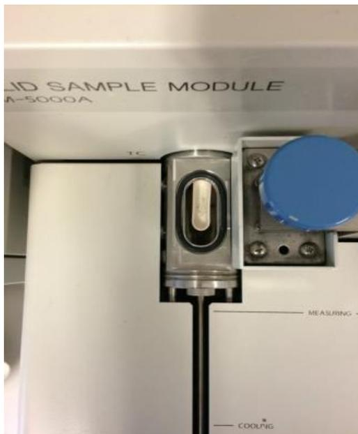
**Εικόνα 26: Εισαγωγή δείγματος στο φούρνο καύσης**
