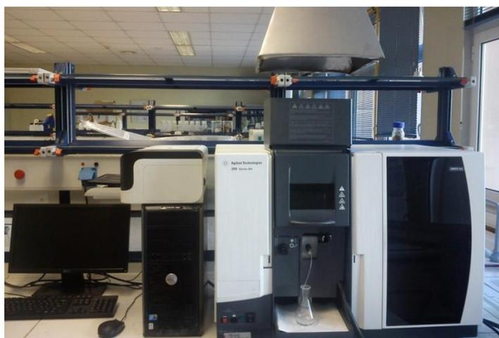
**Εικόνα 24: Φασματοφωτόμετρο Ατομικής Απορρόφησης Agilent AA240 FS**
