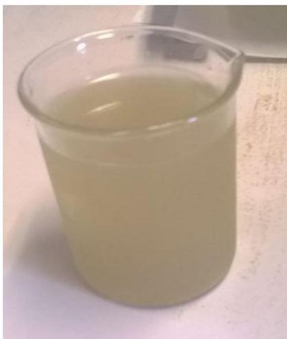
**Εικόνα 34: Υ10.1-3: Δείγμα υγρού απόβλητου από βιομηχανία σφαγής, επεξεργασίας και τυποποίησης κρέατος B10.1-3**
