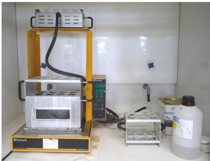
**Εικόνα 27: Συσκευή χώνευσης Gerhard Kjeldatherm KB / KBL**
