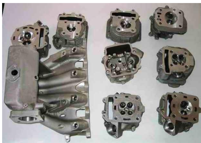
Εικόνα 2.11 Εξαρτήματα κινητήρα από αλουμίνιο παραχθέντα με χύτευση σε μόνιμο τύπο
