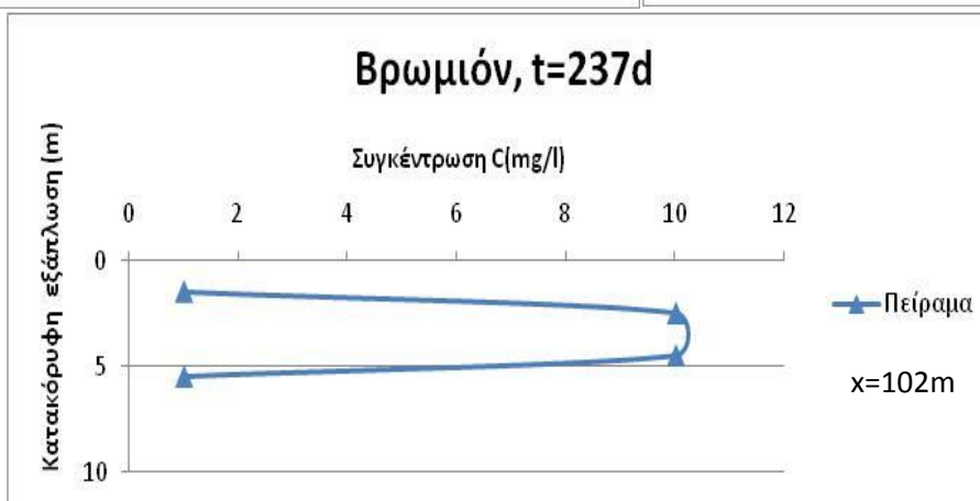
Σχήμα 3.25 Κατανομές των συγκεντρώσεων του βρωμιόντος από το πείραμα τη χρονική στιγμή 237 ημέρες μετά την εισπίεση, στον άξονα x (διεύθυνση υπόγειας ροής) (α) και στους άξονες y (β) και z (γ). Τα διαγράμματα (α) και (β) προκύπτουν από τις μέγιστες συγκεντρώσεις από κάθε πηγάδι δειγματοληψίας
