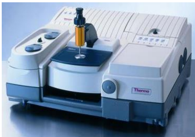
Εικόνα 3-7 Φασματοφωτόμετρο Υπερύθρου Μετασχηματισμού Fourier (FTIR), Nicolet 6700 thermoscientific, διακριτικής ικανότητας 4\text{ cm}^{-1} , με Αποσβένουσα Ολική Ανάκλαση (ATR) [82]
