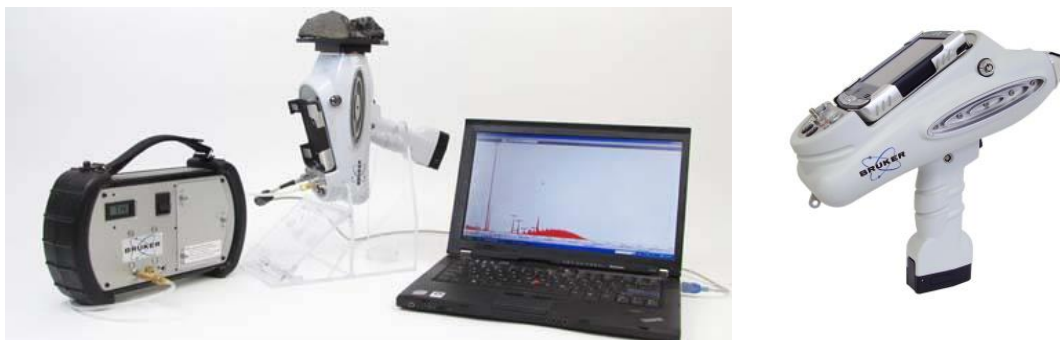
Εικόνα 3-5 Φορητή συσκευή XRF τύπου Tracer III-V της Bruker-AXS [73]
