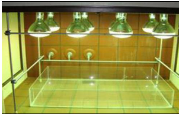
Εικόνα 10. Μονάδα ηλιακής ξήρανσης
