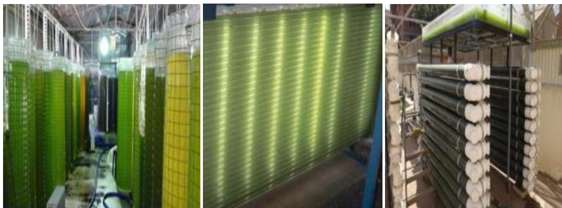
Εικόνα 6. Διάφοροι τύποι συστημάτων καλλιέργειας μικροφυκών: 1) Πλαστικοί σάκοι 300 λίτρων, 2) επίπεδοι φωτοαντιδραστήρες, 3) οριζόντιοι σωληνωτοί φωτοαντιδραστήρες
