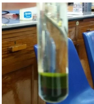
Εικόνα 12: Οι δύο στιβάδες που προκύπτουν μετά την φυγοκέντρηση του διαλύματος Spirulina Platensis -εξανίου και την απομάκρυνση της πρώτης φάσης (υπερκείμενο).
