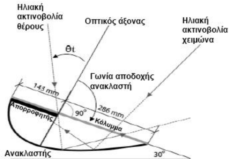
Σχήμα 4 – Σκαρίφημα του συλλέκτη Solarus V11
