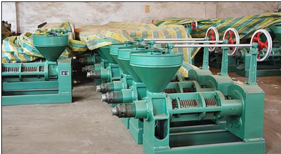
Εικόνα 2.1. Κοχλιοπρέσες για εξαγωγή φυτικών ελαίων από καρπούς.
