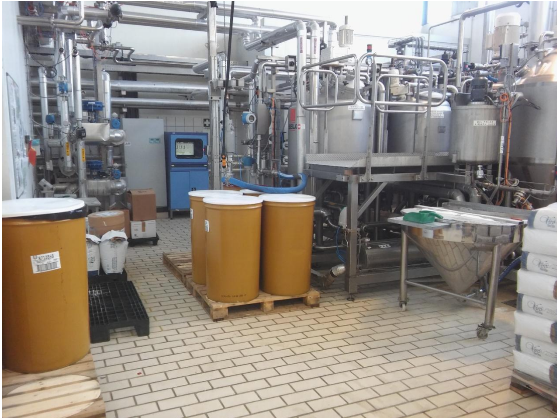
Εικόνα 8: Παλέτες με βαρέλια τοματοπολτού στην αντλία της μηχανής, τοποθέτηση άδειων βαρελιών στη παλέτα, παλέτα ζάχαρης δίπλα στο hopper στην μηχανή Selo
