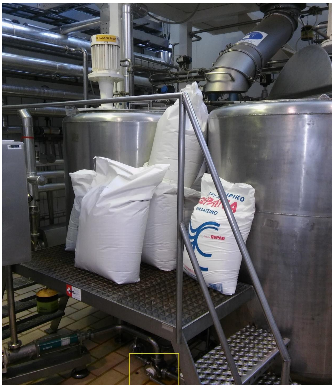
Εικόνα 4: Δυσπρόσιτη βαλβίδα στο παρασκευαστήριο της Μουστάρδας
