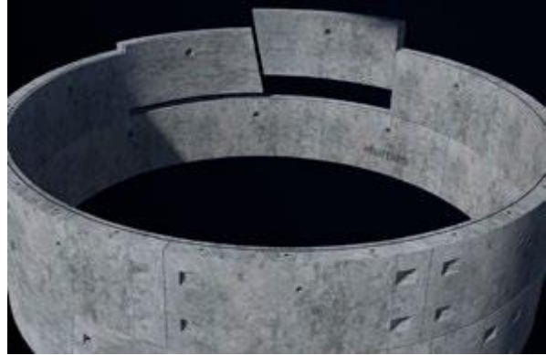
Εικόνα 4 : Τα δύο σφηνοειδή τεμάχια κατά την κατασκευή του “segmental ring”.
