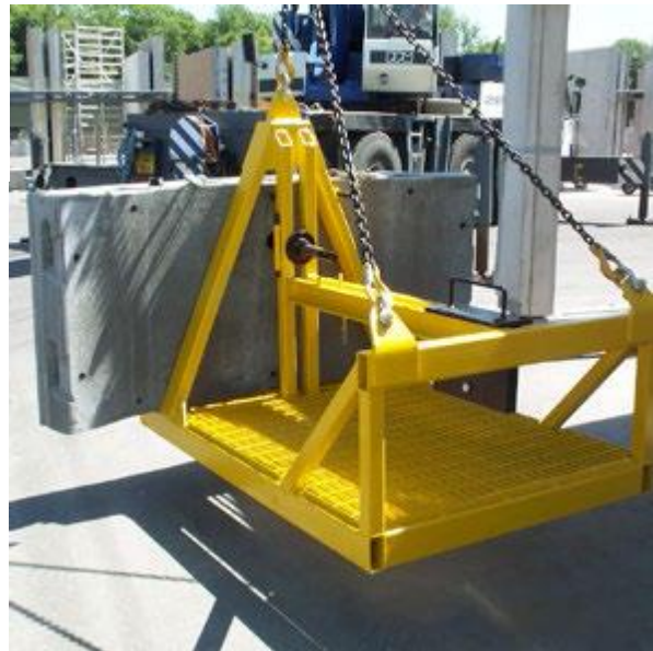
Εικόνα 3 : Ειδικός αναρτήρας για την τοποθέτηση των “segments”.
