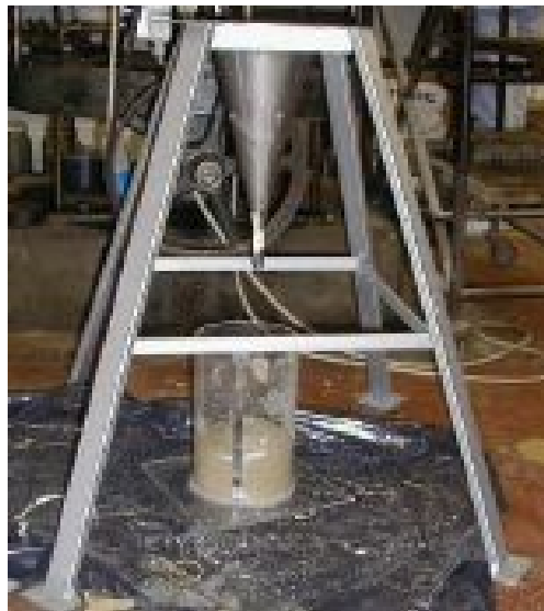
Εικόνα 7. Έλεγχος ρευστότητας σε κώνο τύπου Marsh
