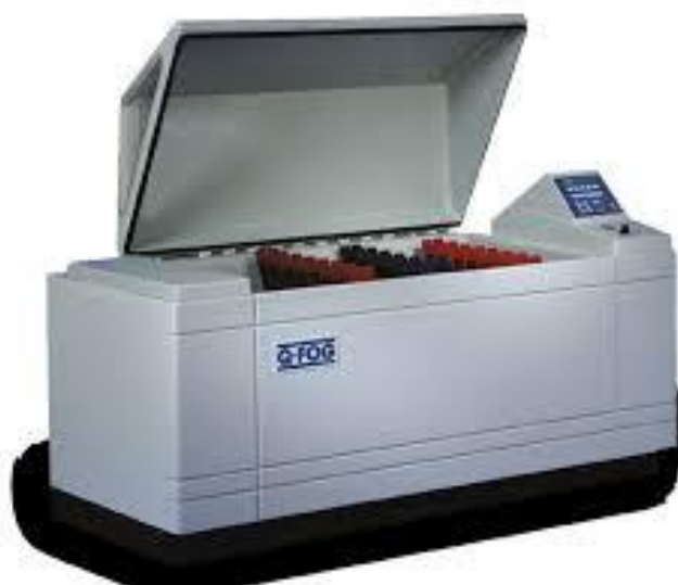
Σχήμα 4.18 : Θάλαμος τύπου Q FOG CCT1100 που χρησιμοποιήθηκε για το πείραμα
