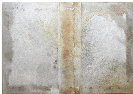
Δοκίμιο HHC11, 5 ημέρες Interval
