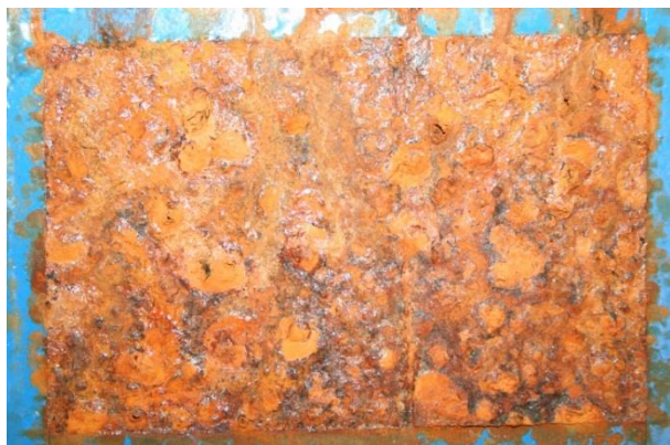
Δοκίμιο CHC9, 10 ημέρες Interval
