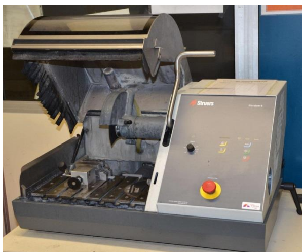
Σχήμα 4.2.α: Δισκοτόμος Μηχανουργείου
