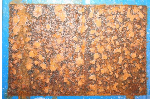
Δοκίμιο CHC11, 5 ημέρες Interval
