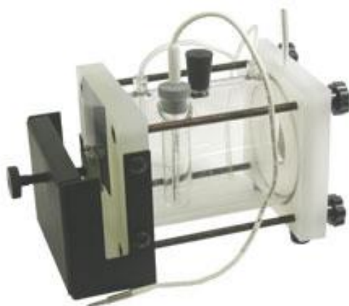
Σχήμα 4.12 : Ηλεκτρολυτικό κελί τύπου K0235 Flat Cell
