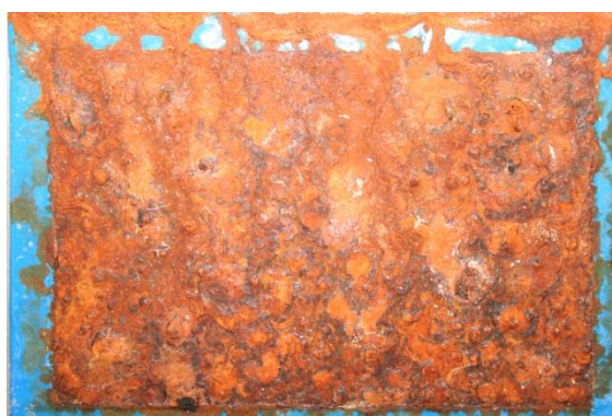
Δοκίμιο HHC8, 20 ημέρες Interval
