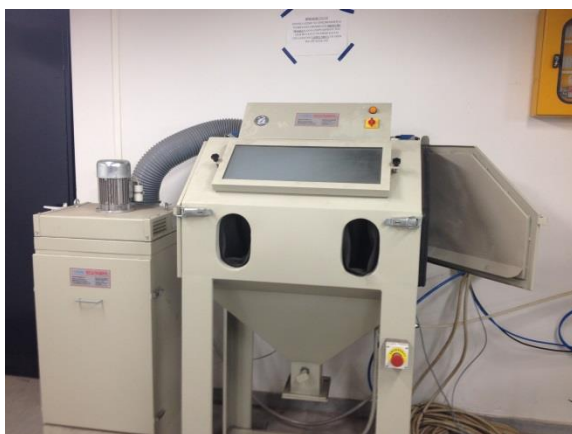
Σχήμα 4.20α : Μηχανή αμμοβολής στο μηχανουργείο του ENT
