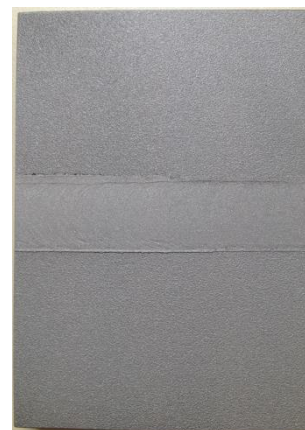
Σχήμα 4.20β : Δοκίμιο μετά από αμμοβολή
