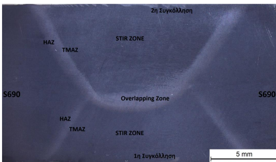
Εικόνα 5.7: Τομή της συγκόλλησης FSW S690-S690
