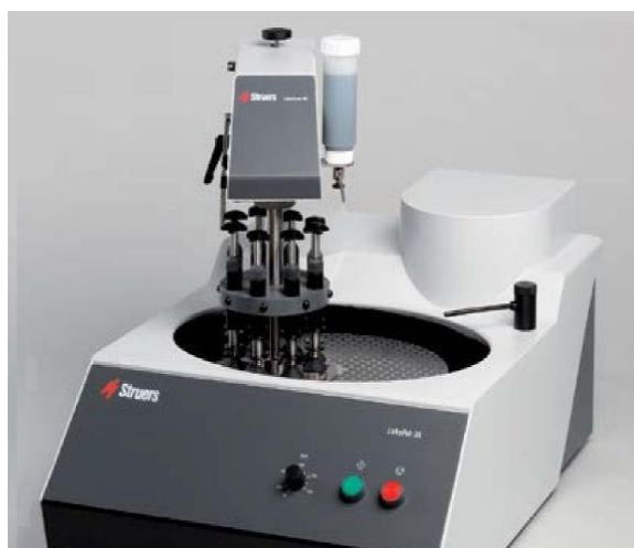
Σχήμα 4.2.β: Μηχανή λείανσης και στίλβωσης
