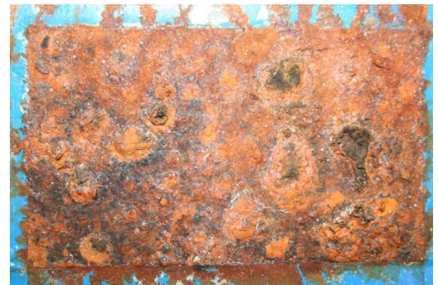
Δοκίμιο CHC7, 25 ημέρες Interval
