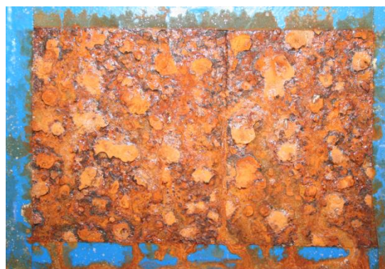
Δοκίμιο HHC10, 10 ημέρες Interval
