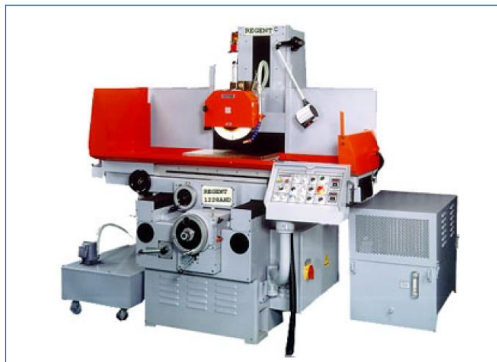
Σχήμα 2: Μηχανή λείανσης με λειαντικό τροχό οριζόντιου άξονα περιστροφής και παλινδρομική τράπεζα [1]
