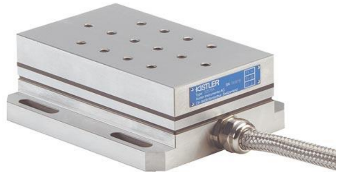
Σχήμα 42: το δυναμόμετρο της εταιρίας Kistler τύπου 9257BA που χρησιμοποιήθηκε στο Εργαστήριο Εξόρυξης Πετρωμάτων Ε.Μ.Π για την μέτρηση των δυνάμεων
