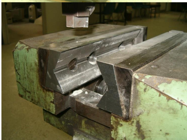
Σχήμα 40: Σιαγωνωτή μέγγενη ειδικά κατασκευασμένη για τη συγκράτηση κυλινδρικών δοκιμίων για την εργαστηριακή διάταξη του Εργαστηρίου Εξόρυξης Πετρωμάτων Ε.Μ.Π.
