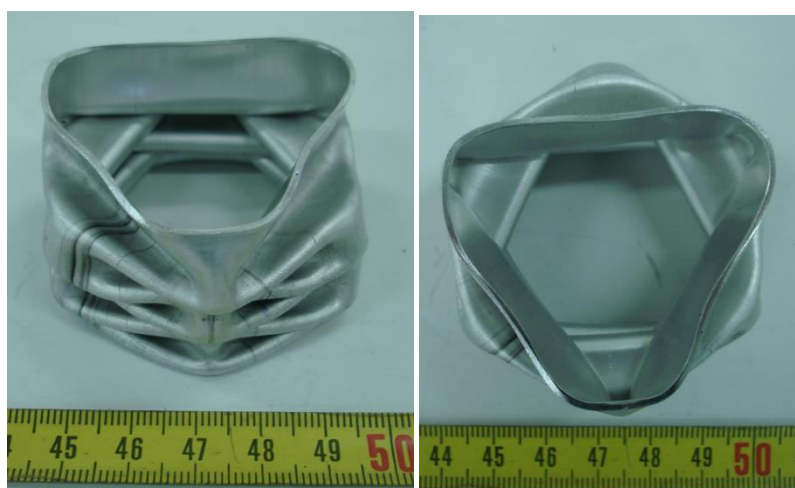
Σχήμα 10: Μη αξονοσυμμετρικός τρόπος κατάρρευσης
