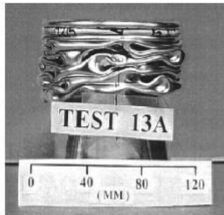
Σχήμα 11: Μικτός τρόπος κατάρρευσης
