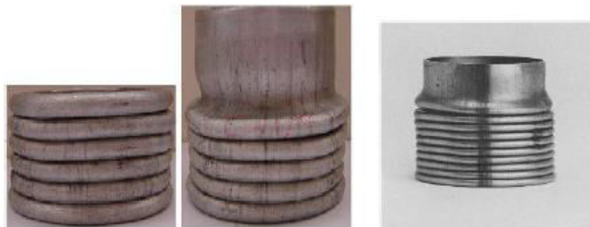
Σχήμα 2: Αξονοσυμμετρικός τρόπος κατάρρευσης
