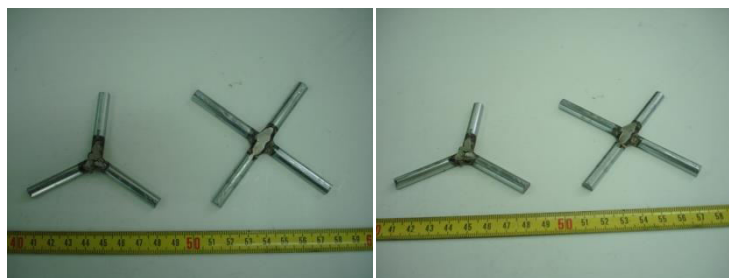
Σχήμα 6: Οι μηχανισμοί triggering T1,T2 από αριστερά προς δεξιά, σε δύο διαφορετικές οπτικές γωνίες.
