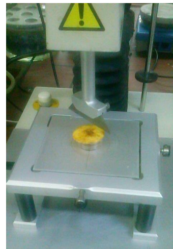
Εικόνα 5.18: Μέτρηση αντικειμενικής σκληρότητας σε plantain τσιπς
