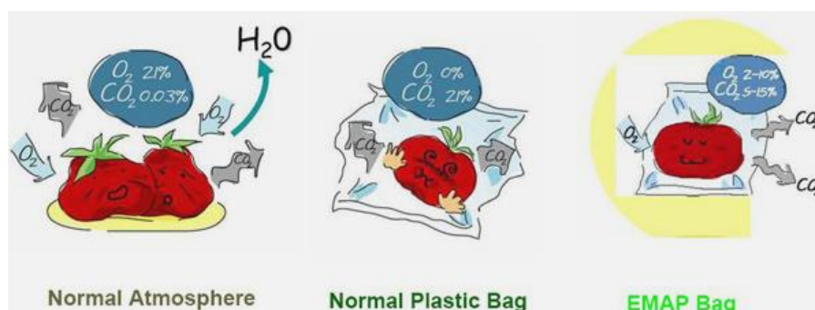
Εικόνα 1.1: Η διατήρηση των φρούτων και των λαχανικών σε τρεις διαφορετικές ατμοσφαιρικές συνθήκες. [25]
