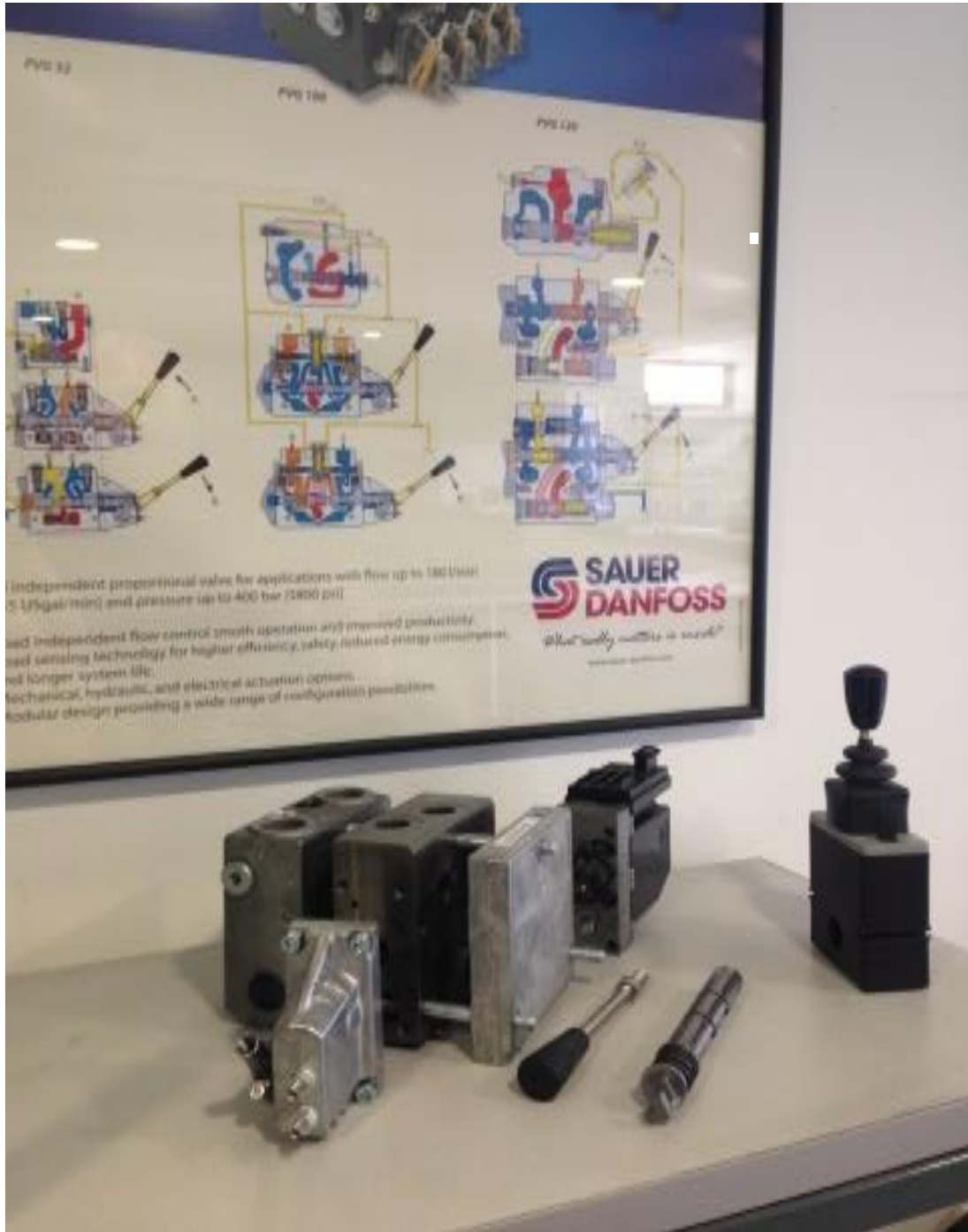
Εικόνα 3.19 ασυναρμολόγητα modules και PVRES
