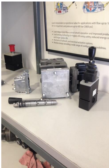
Εικόνα 3.21 ασυναρμολόγητα modules και PVRES
