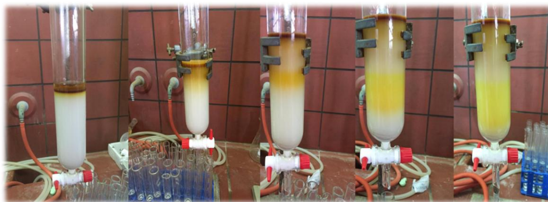
Εικόνα 34 : Η διαδικασία διαχωρισμού των συστατικών του δείγματος με χρωματογραφική στήλη και η λήψη κλασμάτων.
