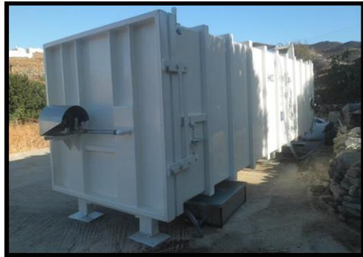
Εικόνα 42 Πλάγια όψη βιοαντιδραστήρα (δεξιά) και όψη τμήματος εξόδου του ώριμου κόμποστ (αριστερά)
