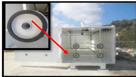
Εικόνα 44 Ζεύγη γαλβανισμένων σωλήνων που διατρέχουν όλο το μήκος του αντιδραστήρα και λεπτομέρεια από τη βάση του σωλήνα που εφαρμόζει στις αντίστοιχες οπές της θύρας εξόδου/εκφόρτωσης.
