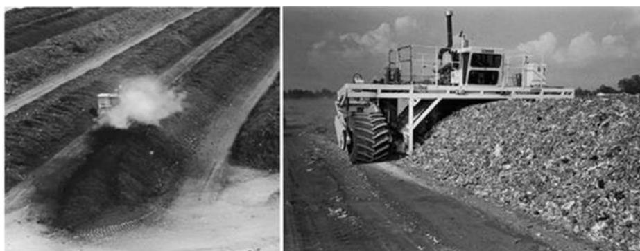
**Εικόνα 14** Τυπική διάταξη οριζόντιου ανοιχτού συστήματος κομποστοποίησης, τύπου αναστρεφόμενων σειραδιών
