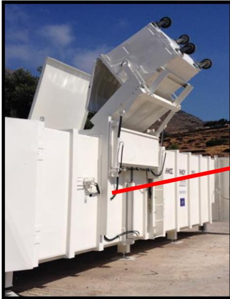
Εικόνα 39 Υδραυλικό σύστημα ανύψωσης κάδου και εκφόρτωσης οργανικού υλικού
