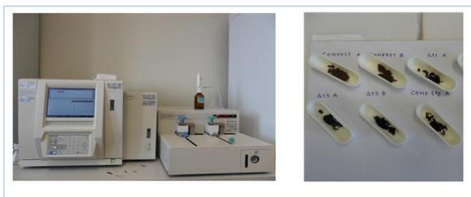
Εικόνα 56 Σύστημα υπολογισμού TOC (αριστερά), πορσελάνινες κάψες με δείγμα (δεξιά)
