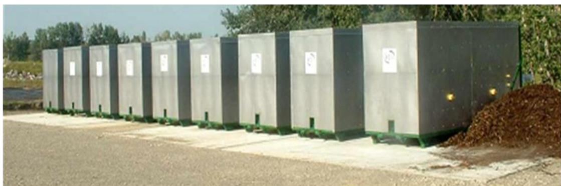
**Εικόνα 11** Τυπική διάταξη οριζόντιων κλειστών συστημάτων κομποστοποίησης, τύπου κιβωτίων, σε παράλληλα στοιχεία
