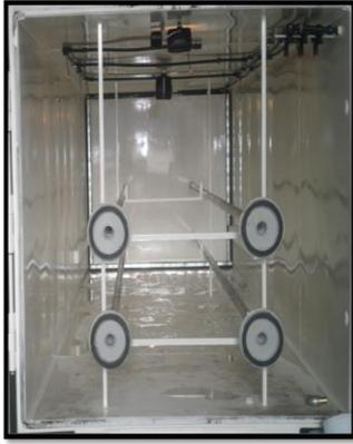
Εικόνα 45 Σύστημα ύγρανσης, (εσωτερικά του βιοαντιδραστήρα) αποτελούμενο από τρεις κλάδους πλαστικών σωλήνων ύδρευσης. Η λειτουργία κάθε κλάδου γίνεται μέσω ηλεκτροβάννας η οποία ελέγχεται από PLC.
