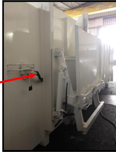
Εικόνα 40 Χειριστήριο υδραυλικού συστήματος ανύψωσης κάδου και εκφόρτωσης οργανικού υλικού
