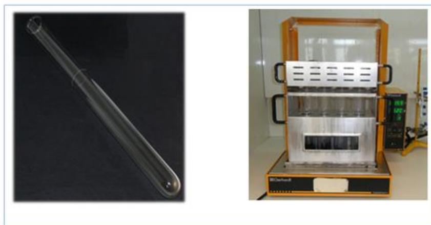
Εικόνα 58 Σωλήνας χώνευσης (αριστερά), συσκευή KJELDATHERM (δεξιά)
