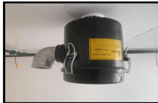
Εικόνα 48 Εσωτερικό τμήμα της διάταξης αναρρόφησης αέρα εντός του βιοαντιδραστήρα
