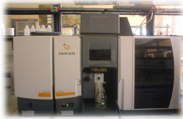
Εικόνα 61 Φασματοφωτόμετρο ατομικής απορρόφησης (Varian)
