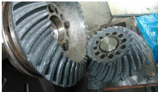
Εικόνα 1.1: Οι δύο οδοντωτοί τροχοί καλυμμένοι με σμυριδαλοφή.
