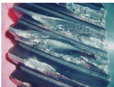
Εικόνα 3.3: Εκκοιλάνσεις στους οδόντες στο τελευταίο τους στάδιο.
