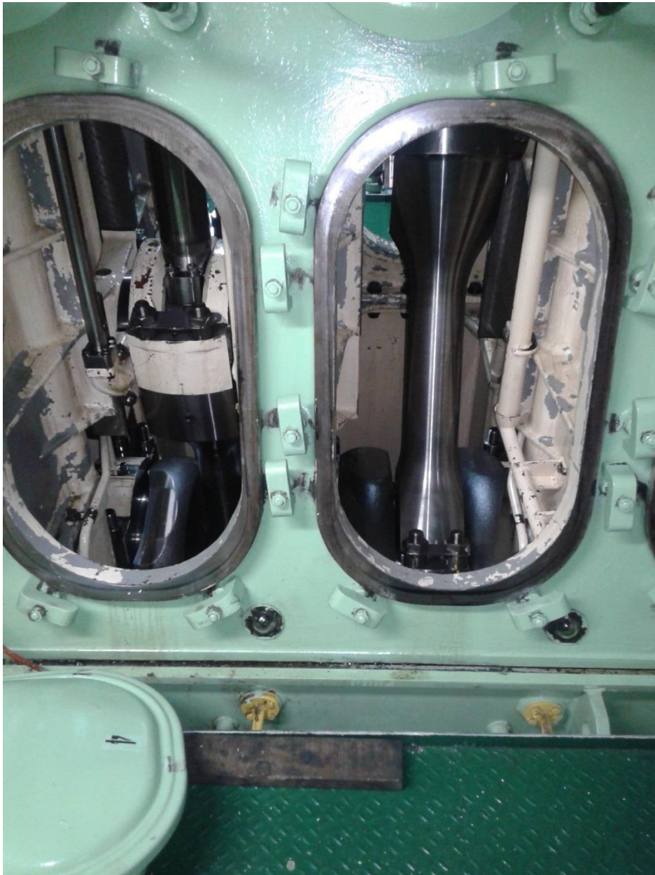
Εικόνα 18 : Έλεγχος συγκεκριμένου σημείου του κινητήρα κατόπιν υπόδειξης της κλάσης (νηογνώμονα).
