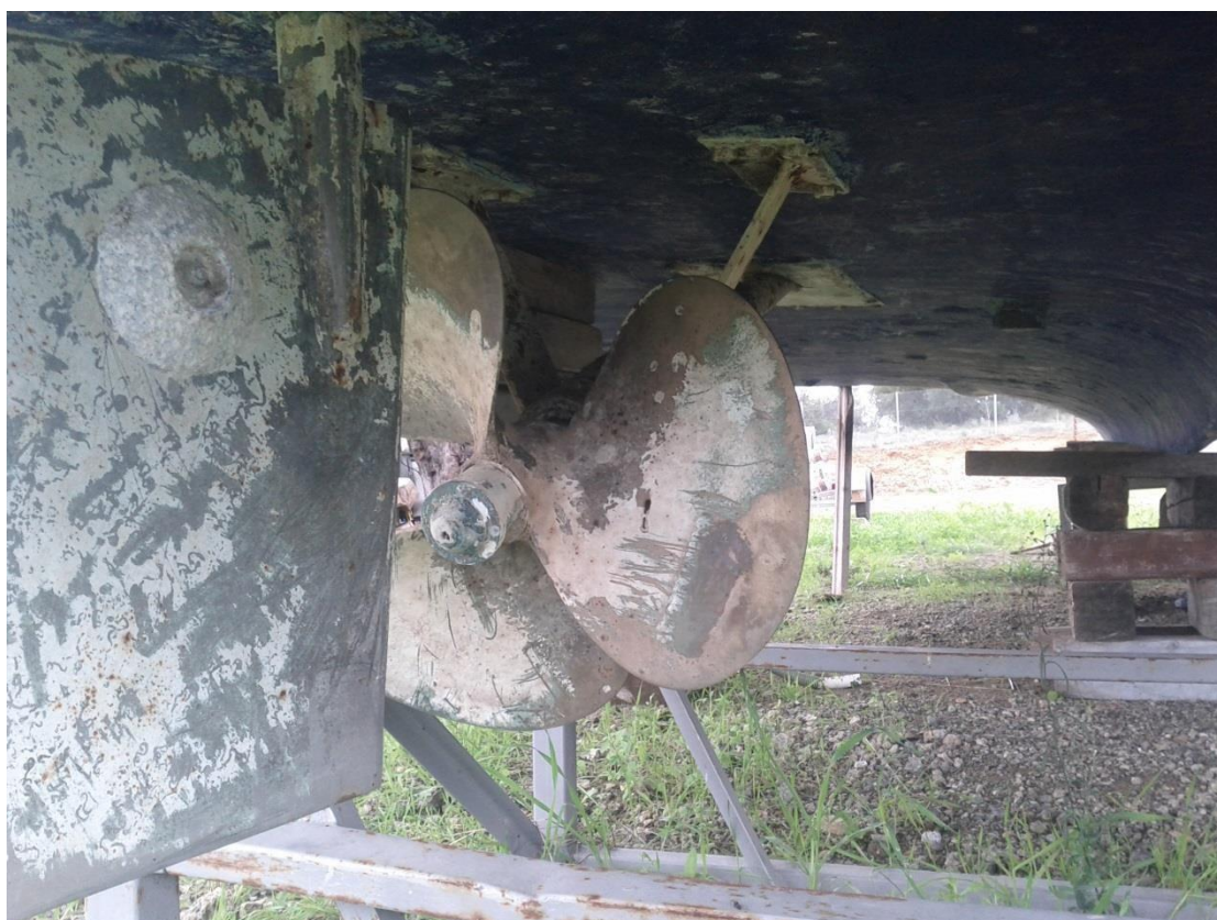
Εικόνα 4 : Σύστημα πρόωσης (έλικα) και ελέγχου (πηδάλιο) 12μετρου σκάφους, στο στάδιο έναρξης επισκευής – συντήρησης. Εδώ ο ναυπηγός έχει συμβουλευτικό ρόλο.
