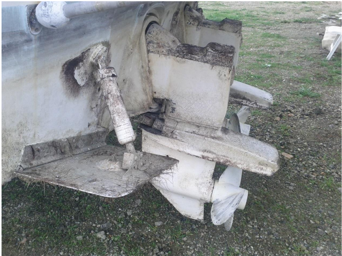
Εικόνα 2 : Σύστημα πρόωσης και ελέγχου διπλέλικου ταχύπλοου 15μετρου σκάφους, στο στάδιο έναρξης επισκευής – συντήρησης. Εδώ ο ναυπηγός έχει συμβουλευτικό ρόλο.
