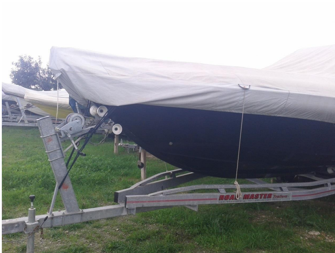
Εικόνα 3 : Γάστρα μετά το πέρας των εργασιών καθαρισμού, έτοιμη προς επιθεώρηση.
