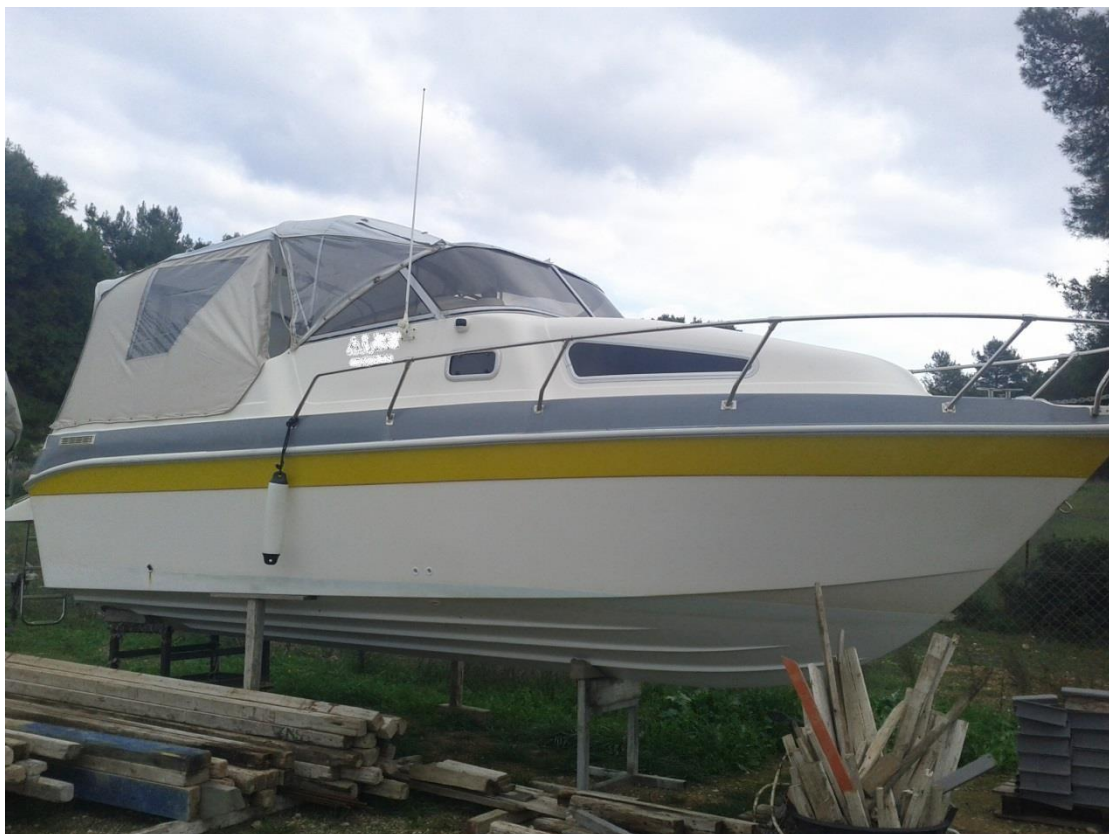
Εικόνα 1 : Γάστρα μετά το πέρας των εργασιών καθαρισμού, έτοιμη προς επιθεώρηση.
