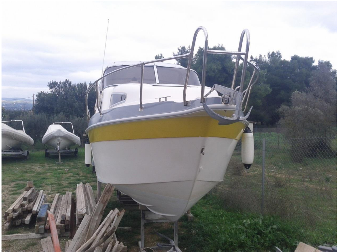
Εικόνες 5,6,7 : Ιδιαίτερη σημασία έχει και η διαδικασία στήριξης του σκάφους στους ξύλινους τάκους. Αυτή γίνεται παρουσία ναυπηγού, λαμβάνοντας υπόψη τα σχετικά έγγραφα – οδηγίες του πλωτού μέσου για τα σημεία επαφής γάστρας – τάκων.
