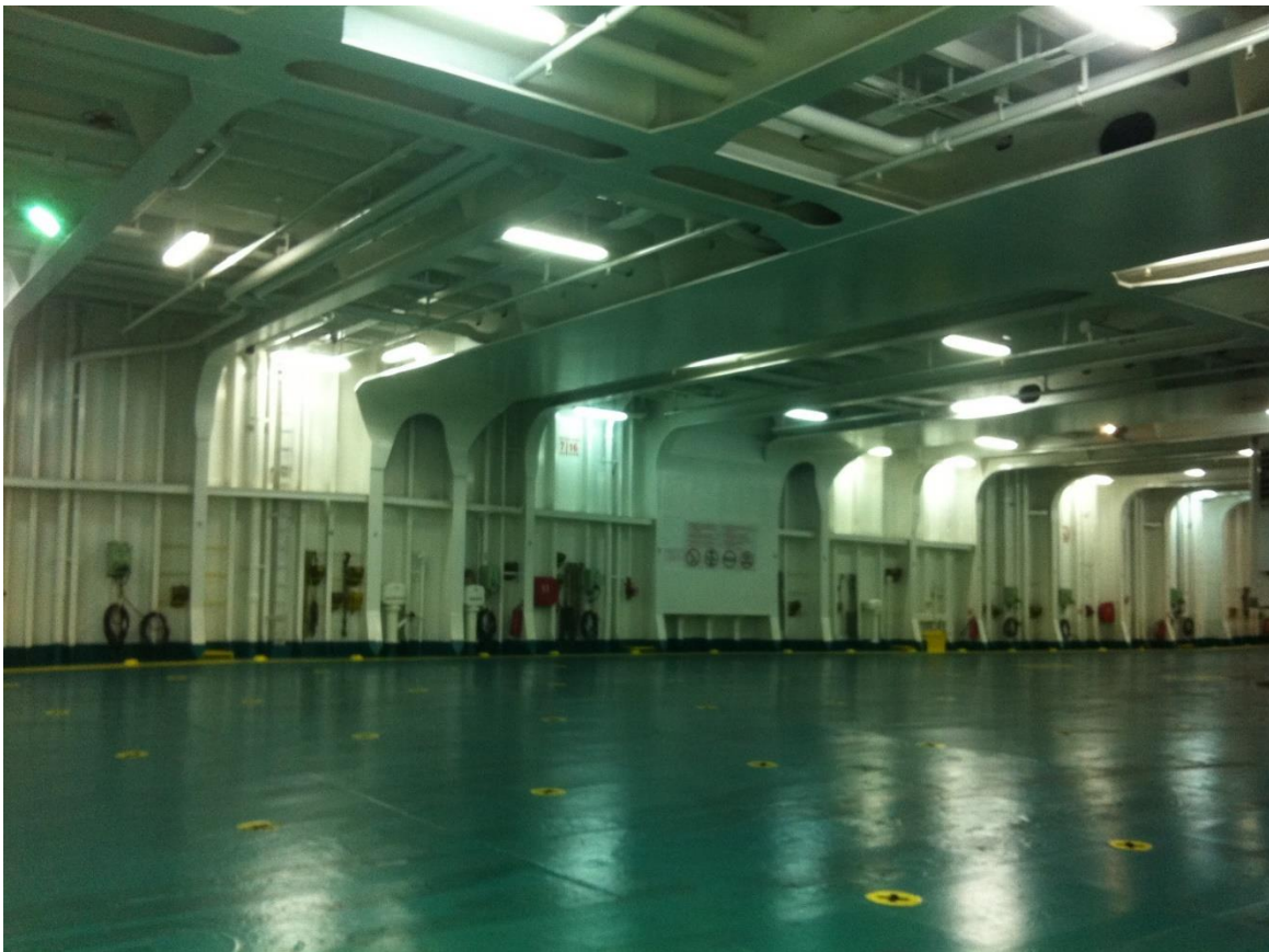
Σχήμα 6.10: Εγκάρσια πλευρική ενίσχυση (Φωτογραφία από το Ε/Γ-Ο/Γ Έλυρος)
