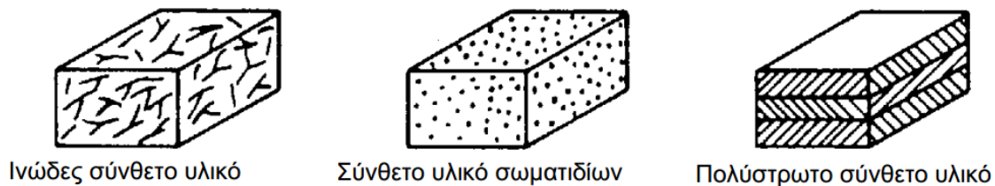
Σχήμα 6.32: Σχηματική αναπαράσταση των διαφόρων ειδών σύνθετων υλικών [92]
