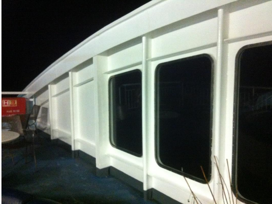
Σχήμα Ζ.3: Διάταξη ορθογωνικών ανοιγμάτων υπερκατασκευής και ενίσχυσή τους (1/2)
