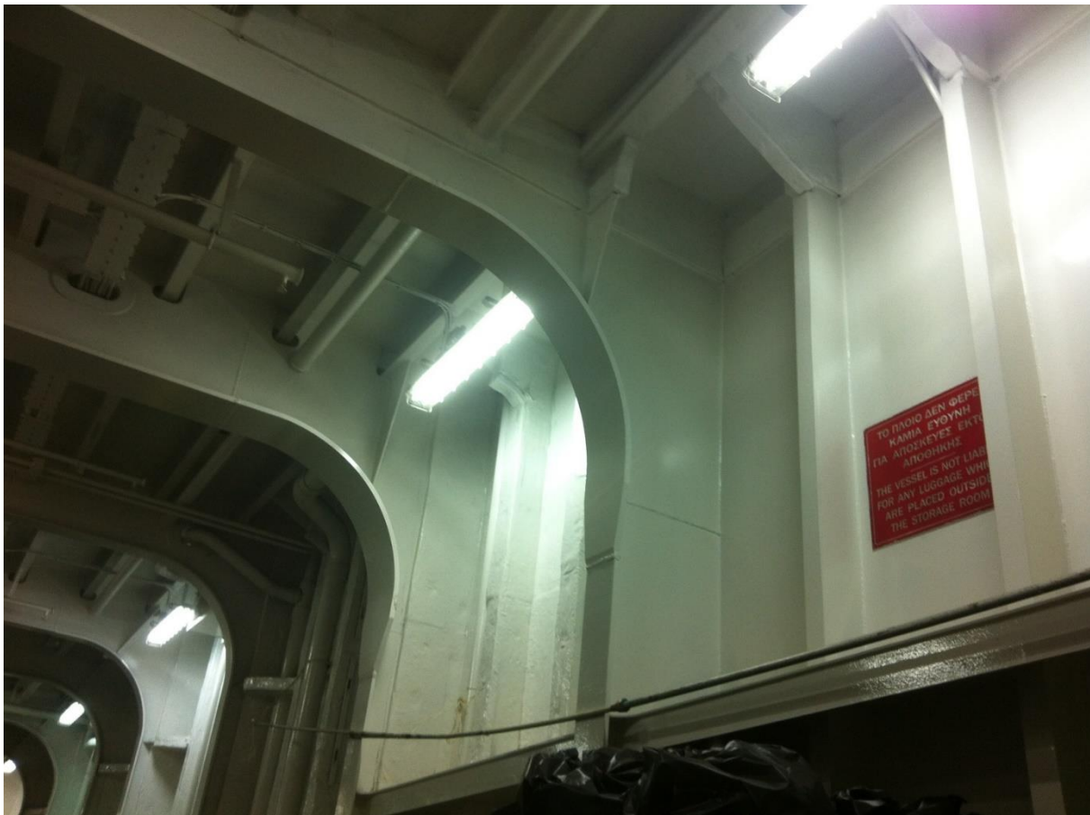
Σχήμα 6.12: Σύνδεση νομέων με το (άνω) κατάστρωμα (Φωτογραφία από το Ε/Γ-Ο/Γ Έλυρος)
