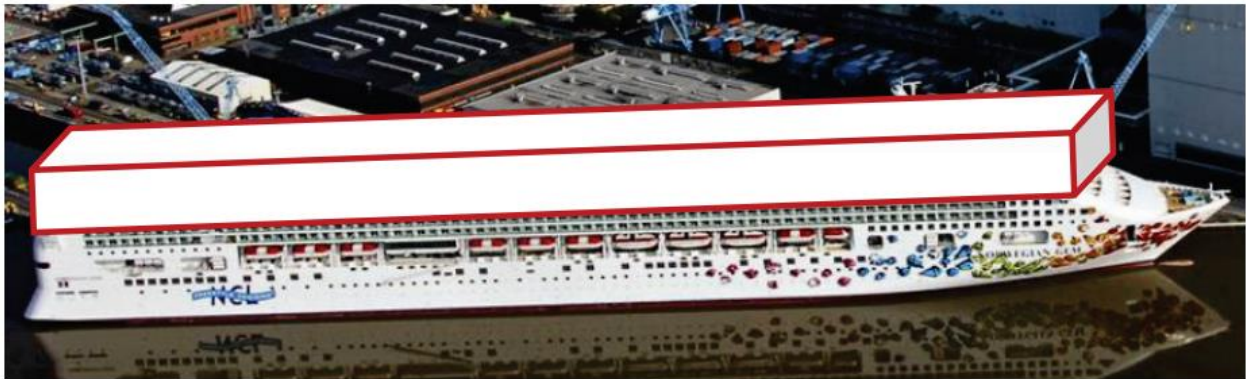
Σχήμα 6.37: Θέση σύνθετων υλικών στην κατασκευή του Norwegian Future [94]
