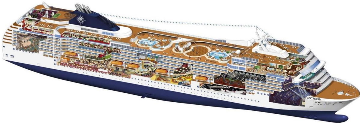
Σχήμα 2.25: Τρισδιάστατο μοντέλο του MSC Poesia στο οποίο παρουσιάζεται η γενική διάταξη [16]
