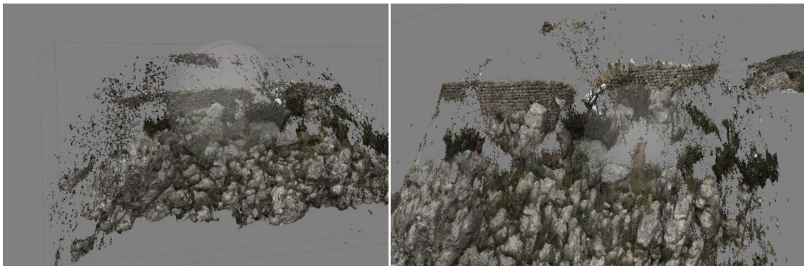
Εικόνα 0-8: Align photos χωρίς μάσκες. Περισσότερος θόρυβος, αλλά πιο σωστή απόδοση του βάθους
