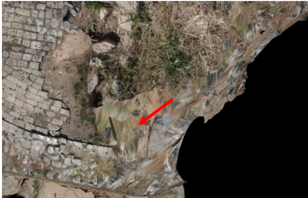
Εικόνα 5-13: Ορθοεικόνα. Απόδοση υφής σε περιοχή με αραιό νέφος λόγω βλάστησης.
