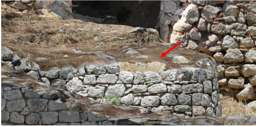
Εικόνα 5-9: Ορθοεικόνα: προβλήματα στην υφή λόγω πυκνότητας του νέφους σημείων.
