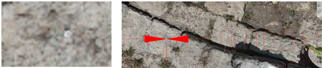
Εικόνα 5-1: Η εικόνα του καρφιού της στάσης Σ4, όπως φαίνεται στην ορθοεικόνα και η θέση του αντίστοιχου σημείου σύμφωνα με τις γεωδαιτικές συντεταγμένες.
