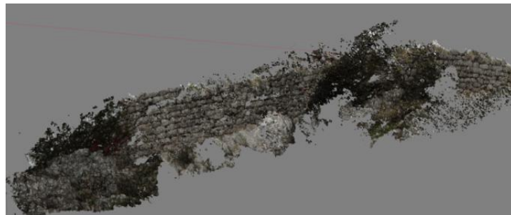
Εικόνα 5-43: ΒΔ τμήμα του Τείχους - Align photos – ρύθμιση LOW
