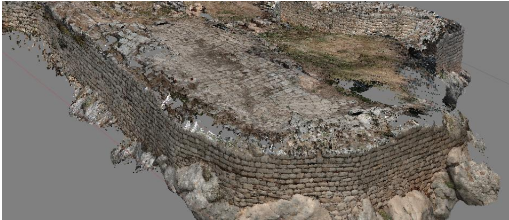
Εικόνα 5-20: Κενά στο νέφος λόγω παρουσίας βλάστησης ή κακής γεωμετρίας εικόνων
