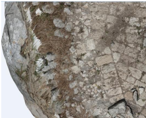
Εικόνα 5-18: Ορθοεικόνα: προβλήματα στην υφή λόγω κενών στο νέφος. Συμπλήρωση στο Geomagic
