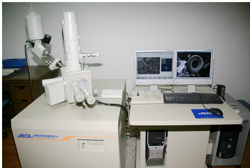
Εικόνα 2.7 Συσκευή μικροσκοπίας SEM με στήλη ανάλυσης EDS
