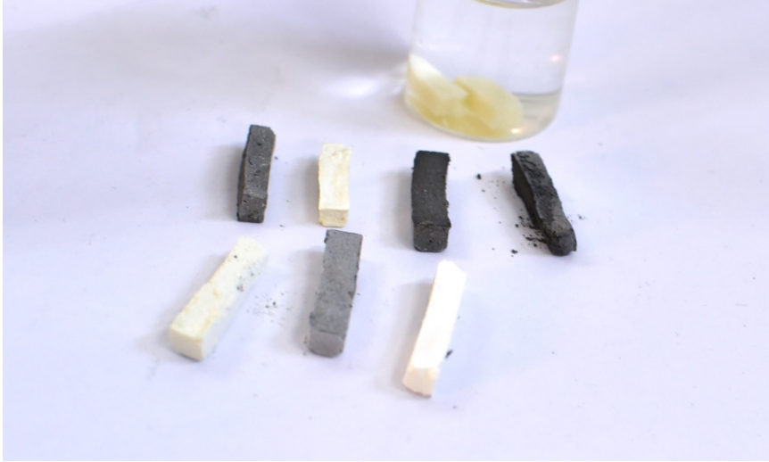
Εικόνα 3.13 Φωτογραφία των τελικών δειγμάτων τρισδιάστατων ικριωμάτων που αναπτύχθηκαν και μελετήθηκαν στην παρούσα έρευνα με προσθήκη (μαύρα) και χωρίς προσθήκη νανοσωλήνων άνθρακα (λευκά). Τα 4 στη πάνω σειρά πρέκυσαν με τη μέθοδο ανάμιξης κόνεως, ενώ τα 3 στην κάτω σειρά με τη μέθοδο ανάμιξης αιωρήματος.
