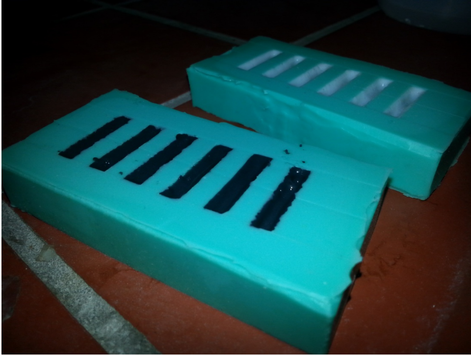
Εικόνα 2.1 Φωτογραφία των καλουπιών που χρησιμοποιήθηκαν για την παραγωγή ικριωμάτων, γεμισμένα με υλικό χωρίς (λευκό) και με νανοσωλήνες (μαύρο), πριν την διαδικασία λυοφιλίωσης.
