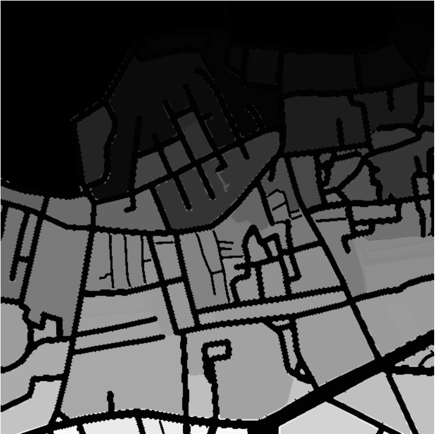
Σχ.4.8 : Αποτέλεσμα τμήματος κώδικα SCRIPT 4 : Εφαρμογή φίλτρου κατάτμησης Watershed στην εικόνα ταξινόμησης Σχ. 4.6. Κάθε απόχρωση του γκρι ορίζει ένα ξεχωριστό, οικοδομικό τετράγωνο και διαθέτει διαφορετική τιμή ID.
