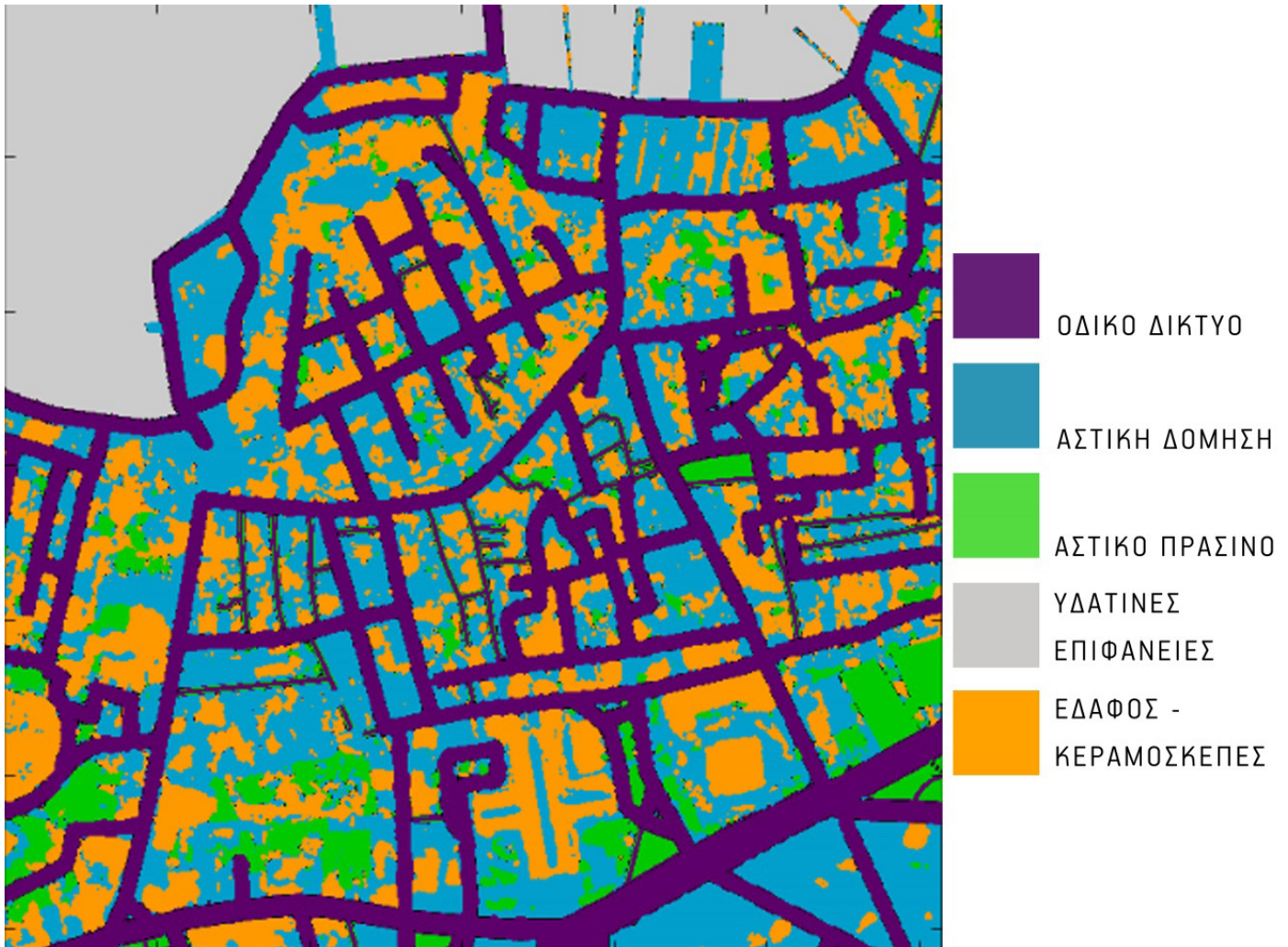
Σχ.4.17 : Αποτέλεσμα τμήματος κώδικα SCRIPT 8 : Τελικός θεματικός χάρτης.
