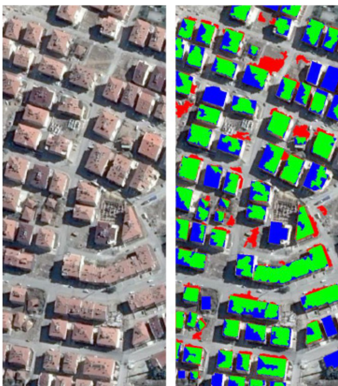
Σχ.2.9 : Δορυφορική εικόνα και το αποτέλεσμα ταξινόμησης της για την προτεινόμενη μέθοδο εξαγωγής κτιριακών οντοτήτων
