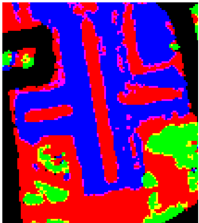
Σχ.5.8 : Δορυφορική απεικόνιση της υποπεριοχής Β.1.2: (αριστερά) και αποτέλεσμα ταξινόμησης για τις τρεις θεματικές κατηγορίες (δεξιά).
