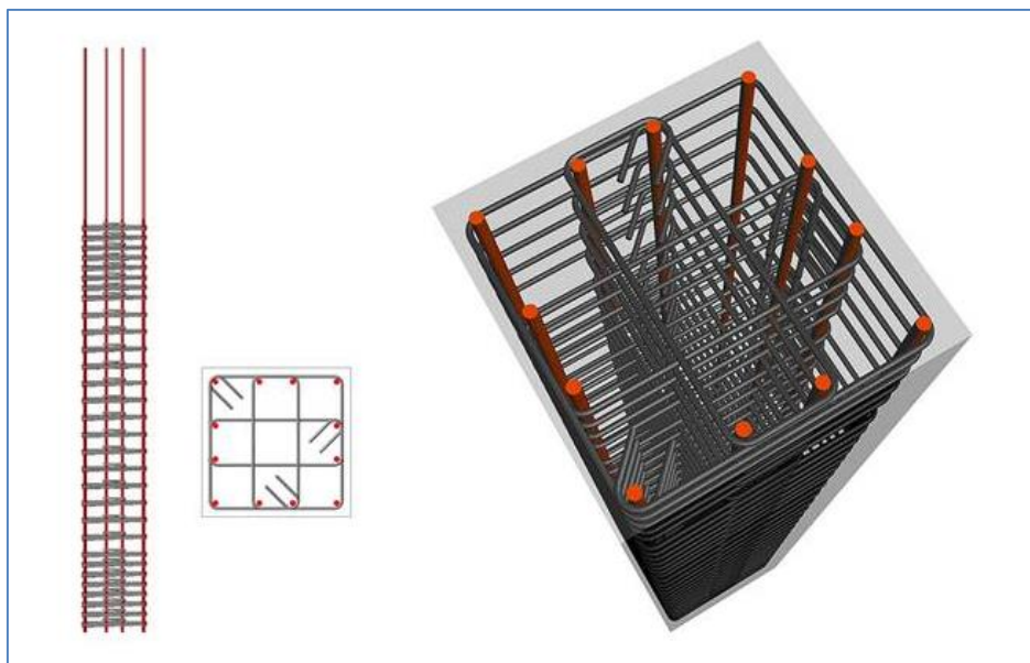
Σχήμα 2.8 Αύξηση πλαστιμότητας μέσω περισφίξεως σε υποστύλωμα
