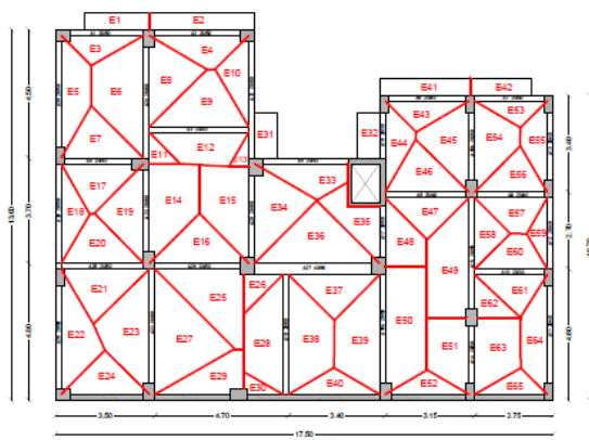
ΕΠΙΦΑΝΕΙΣ ΦΟΡΤΙΣΗΣ ΔΟΚΩΝ ΥΠΟΓΕΙΟΥ
