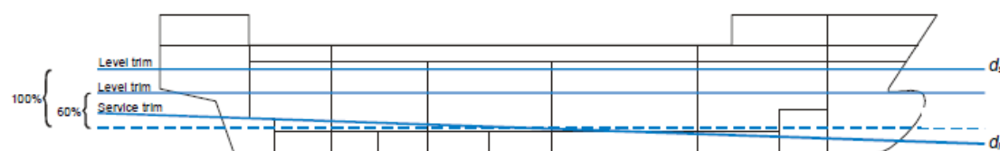
Σχήμα 4.2-5: Βυθίσματα υπολογισμού επιτευχθέντος δείκτη υποδιαίρεσης, σύμφωνα με τον κανονισμό
