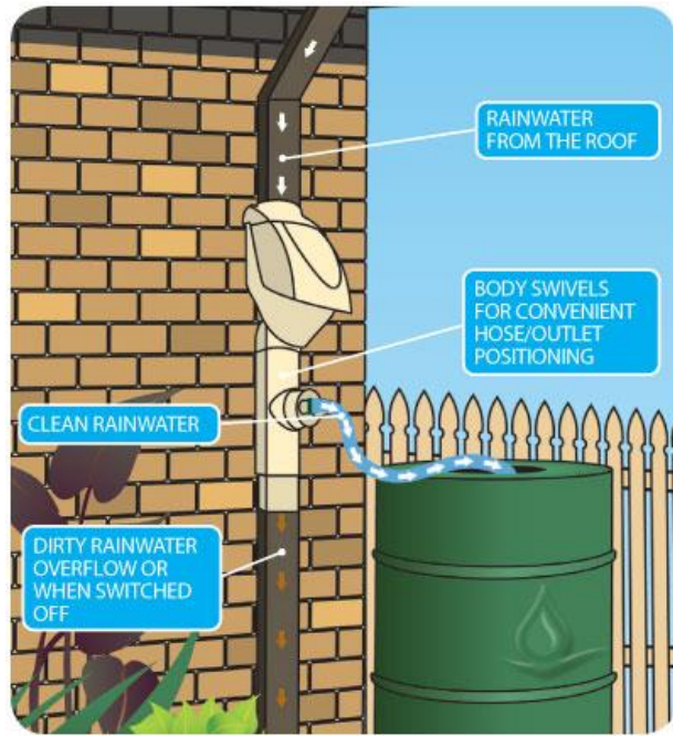
Εικόνα 3.9 Φίλτρο και εκτροπή της πρώτης έκπλυσης σε συστήματα συλλογής όμβριων υδάτων (Πηγή: http://www.aquabarrel.com/product_multifunctional_downspout_devices.php )
