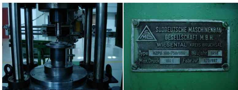
Ε.Π.1.3: αριστερά :Πρέσα όπου συμπιέστηκαν οι κόνεις του πρώτου κύκλου πειραμάτων, διακρίνονται η μήτρα, το έμβολο , δεξιά : ο τύπος , το μέγιστο φορτίο , η προέλευση και η μάρκα της πρέσας
