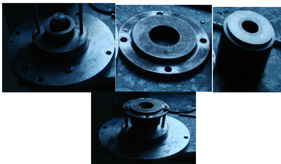
Ε.Π.1-4: εξαρτήματα μήτρας, η συναρμολογημένη μήτρα
