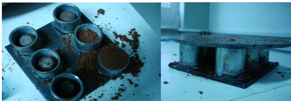
Ε.Π.2.-1 ΔΕΞΙΑ ΚΑΙ ΑΡΙΣΤΕΡΑ : καλούπι δοκιμίων
