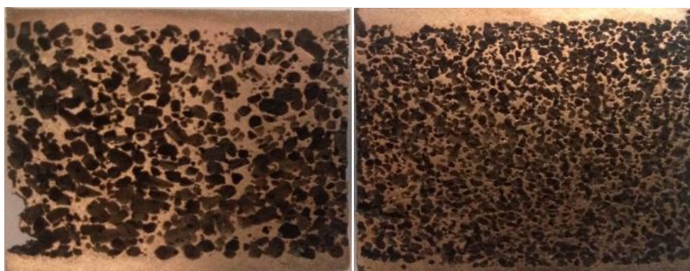
ΕΙΚΟΝΑ.Π.5-3: ΤΟΜΕΣ ΔΟΚΙΜΙΩΝ ΚΑΣΤΑΝΗΣ (ΑΡΙΣΤΕΡΑ) , ΑΣΠΡΗΣ (ΔΕΞΙΑ)
