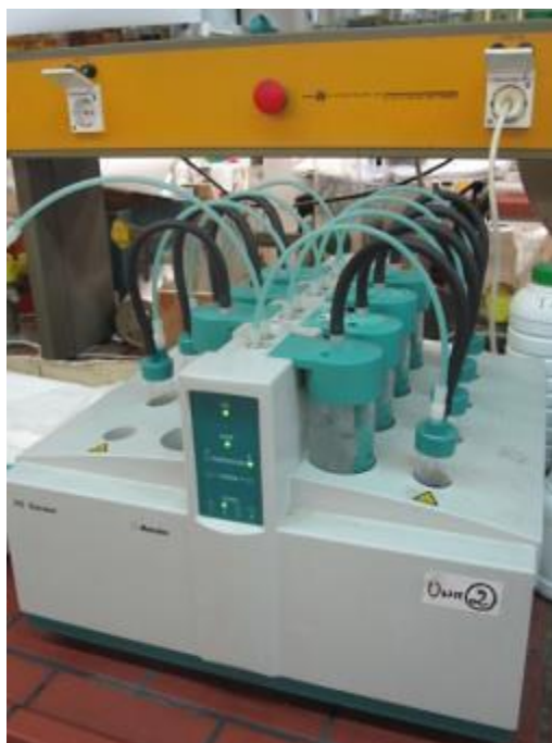
Εικόνα 4.6: Όργανο Rancimat για τη μέτρηση της οξειδωτικής σταθερότητας μιγμάτων βιοντήζελ ή καθαρού βιοντήζελ [41]
