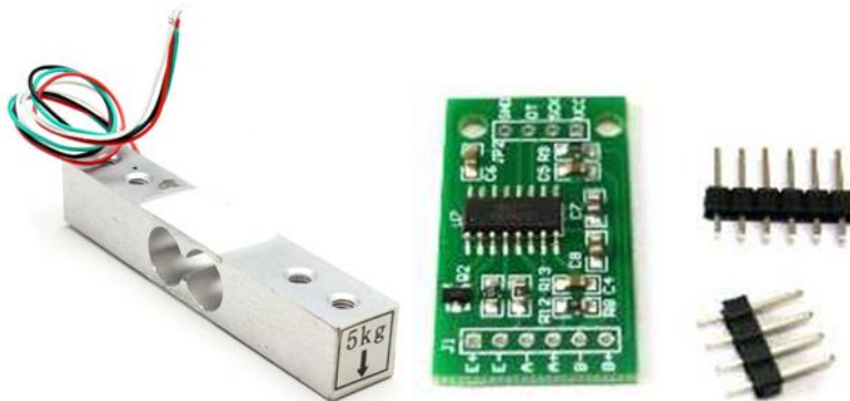
Εικόνα 31: Αριστερά το load cell, δεξιά το HX711
