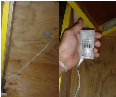
Εικόνα 56: Οι αισθητήρες υγρασίας και θερμοκρασίας μέσα στην κυψέλη.
